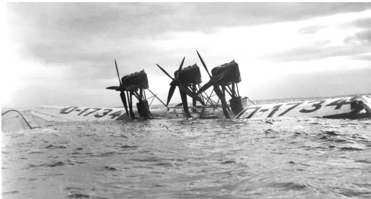
Das große Flugboot Rohrbach „Romar“ D-1734 stürzte am 10. September 1929 in der Nähe von Grömitz in die Ostsee. Es befand sich auf einem Probeflug in niedriger Höhe über dem Meer (zwecks Untersuchung des sog. Luftkissen-Effekts), als unvermittelt das rechte der drei Triebwerke aussetzte. Die beim Aufschlag auf das Wasser entstandenen Lecks waren so erheblich, daß die Maschine nach relativ kurzer Zeit sank. Das Wrack wurde zwar wieder gehoben, aber dann verschrottet. Die offizielle Ausbuchung der D-1734 in den amtlichen NfL (Nachrichten für Luftfahrer) erfolgte erst mit 2 ½ jähriger Verspätung. (Slg. Frost/ADL)
