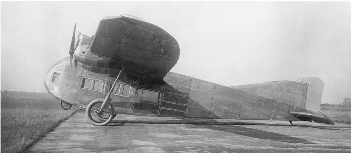
*Die von Rohrbach konstruierte E 4/20 der Zeppelinwerke Staaken war ein Ganzmetall-Verkehrsflugzeug mit vier Maybach-Motoren, dessen Zelle aerodynamisch hervorragend durchgebildet war. Es wurde September 1920 fertiggestellt und konnte 12 bis 18 Passagiere befördern. (Das kleine Bugrad wurde bald wieder entfernt).*
