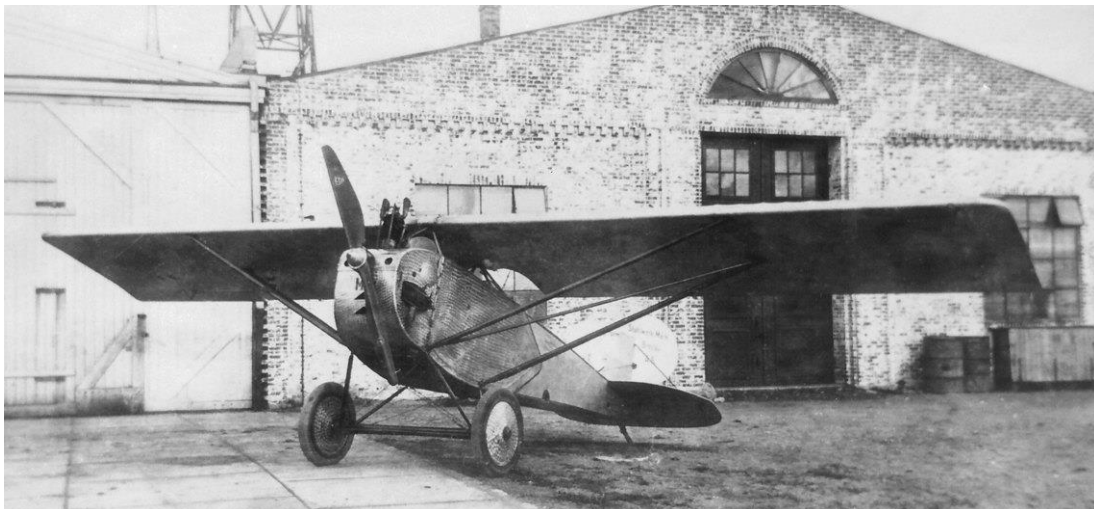
Die Mark R IV 23 glich in ihrer äußeren Erscheinung sehr stark der R III, hatte aber zwei hintereinander liegende Sitzplätze und eignete sich dadurch auch als Schulflugzeug. Das Bild oben zeigt die Werknummer 204, die sich zumindest zeitweilig beim Westfalenwerk aufhielt. Die genaue Identität der Maschine auf dem unteren Foto ist ungeklärt, sie war in Hamburg im Einsatz und trug keine Zulassung, sondern nur den Namen „Max“ am Bug unterhalb der Propellerwelle.
