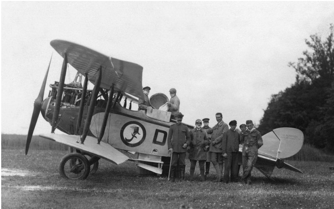
Die LVG C VI, Kennzeichen D-797, diente bei der Firma Fuhrken sowohl im Rundflugbetrieb als auch zur Bekämpfung von Forstschädlingen. Hier wird gerade der im Passagierabteil eingebaute Streugutkasten von oben mit Calciumarsenat befüllt. (Luftfahrtarchiv Matthiesen)
