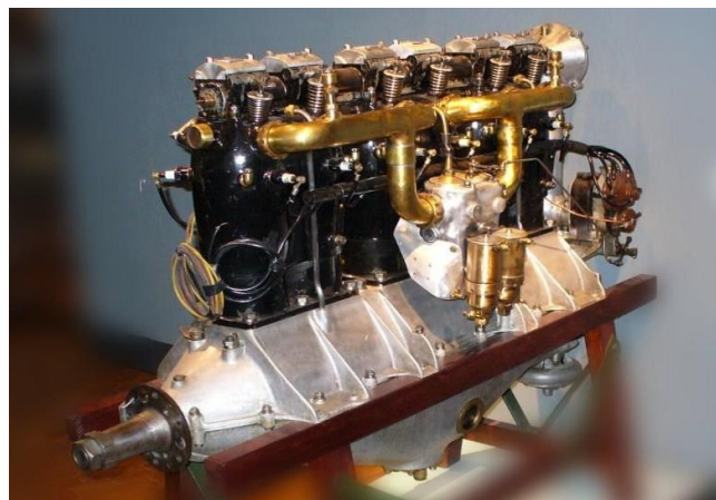
Der 6-Zylinder-Reihenmotor Mercedes D II diente u.a. als Antrieb vieler Albatros B II-Flugzeuge. (Wikimedia)
