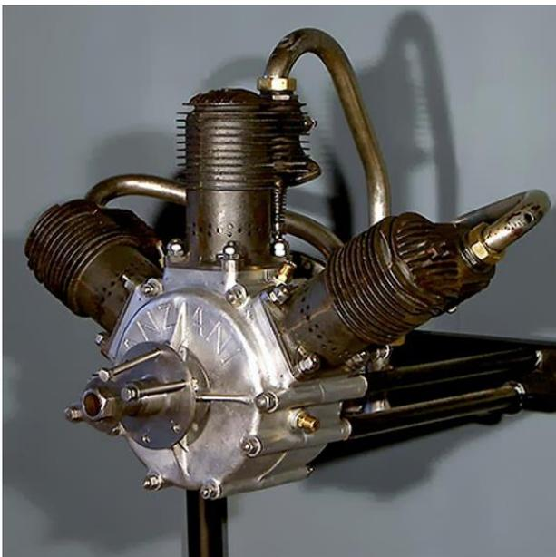
*Ein französischer Fächermotor vom Typ Anzani war vermutlich in den verunglückten Hochdecker eingebaut. Die Bezeichnung „Fächermotor“ bzw. „Fächerbauweise“ rührt daher, daß die drei Zylinder nicht in Sternform angeordnet waren, sondern nur das obere Drittel des Kurbelgehäuses einnahmen. Das äußere Erscheinungsbild des Triebwerks erinnerte dadurch entfernt an einen Fächer.
