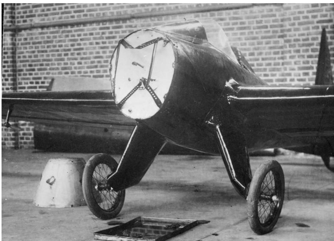
Bei den beiden Aufnahmen dürfte es sich um ein und dieselbe Maschine handeln: Auffallende Übereinstimmungen gibt es bei der spitzen Formgebung des Seitenleitwerks, bei der halboffenen Führersitzhaube sowie beim Hauptfahrwerk ohne durchgehende Achse und mit strömungsgünstig verkleideten Streben zum Rumpf.
