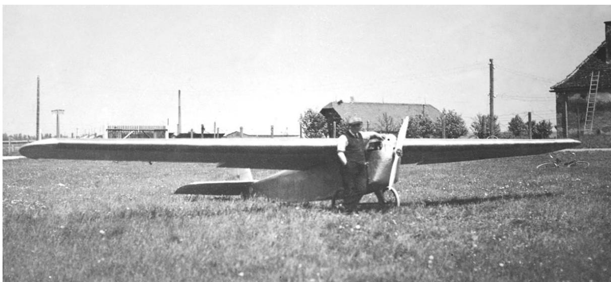
Die Maschine Nr. 05 war ein (vermutlich) einsitziges Sportflugzeug. Die Flügel wiesen eine relativ große Spannweite auf und waren freitragend in Schulterdecker-Bauweise auf der Rumpfoberseite angebracht. Zum Antrieb diente, soweit erkennbar, ein kleiner Zwei- oder Vierzylinder-Reihenmotor, dessen Fabrikat auf dem Foto nicht genau auszumachen ist. Möglicherweise handelte es sich um einen 15/18 PS-DKW.
