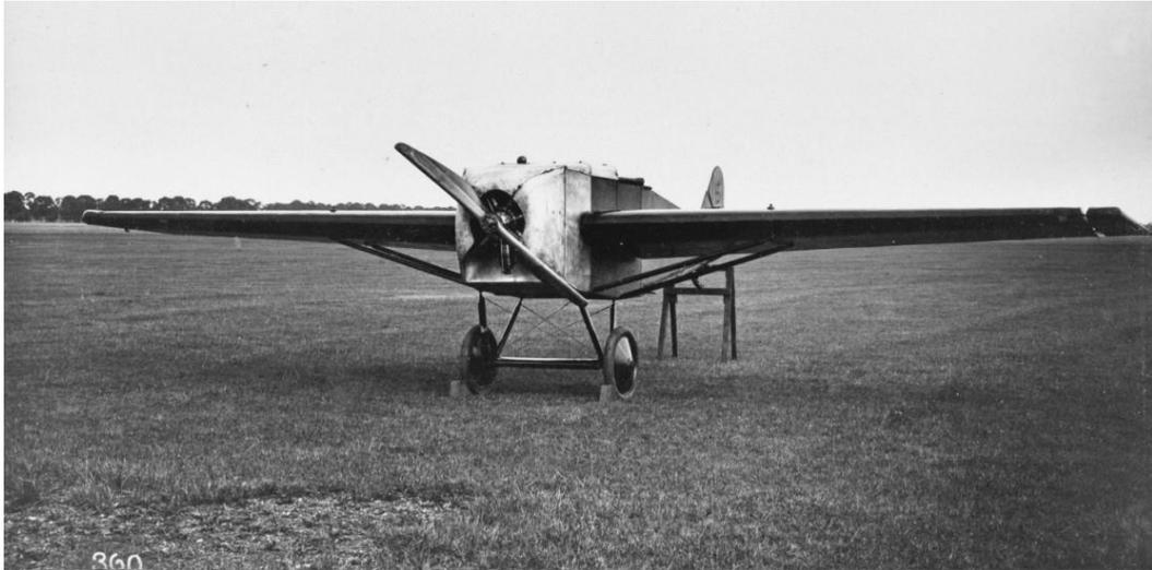
*Drei Ansichten des fertigen Flugzeugs Habenschaden-Scheubeck HS 1. Bei der Rückansicht sind deutlich die Endklappen an den Tragflächen zu erkennen. In der Seitenansicht fällt am Seitenleitwerk die Typenbezeichnung HS 1 ins Auge.<sup>14)</sup>*
