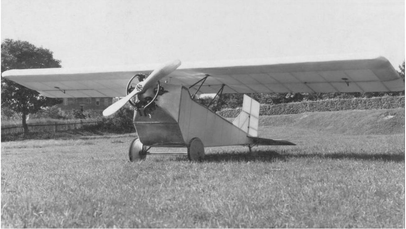
*Der flugfertige Hochdecker Voigt-Langguth VL-1 „Memmingen“. Die Maschine war einsitzig ausgelegt und wurde von einem französischen Sechszylinder-Sternmotor Fabrikat Salmson (60 PS/44 kW) angetrieben.*
