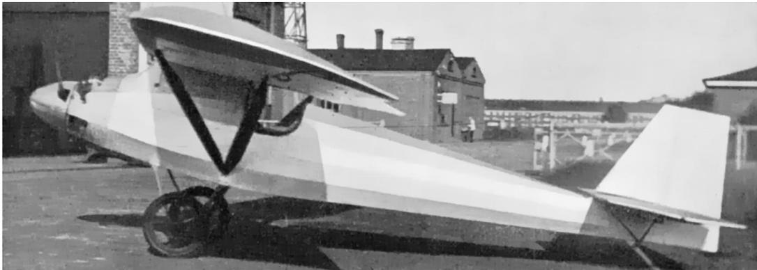
*(oben): Wagener HW 4 mit Vierzylinder-Sternmotor Fabrikat Festenberg-Pakisch in Zweitakt-Bauart, Leistung 14 PS (10,3 kW).*
