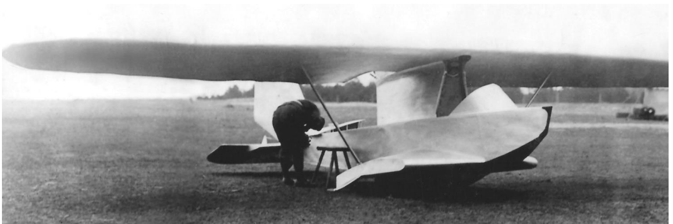
Auf diesem Foto ist gut der Ansaug- und Kühlluftkanal für den „Victoria“-Boxermotor oben unter dem Mittelflügel zu erkennen. Die Stabilisierungsflossen an der Rumpfunterseite zeigen eine deutliche Profilgebung und einen relativ großen Anstellwinkel. (Slg. Manfred Krieg, Erfurt)
