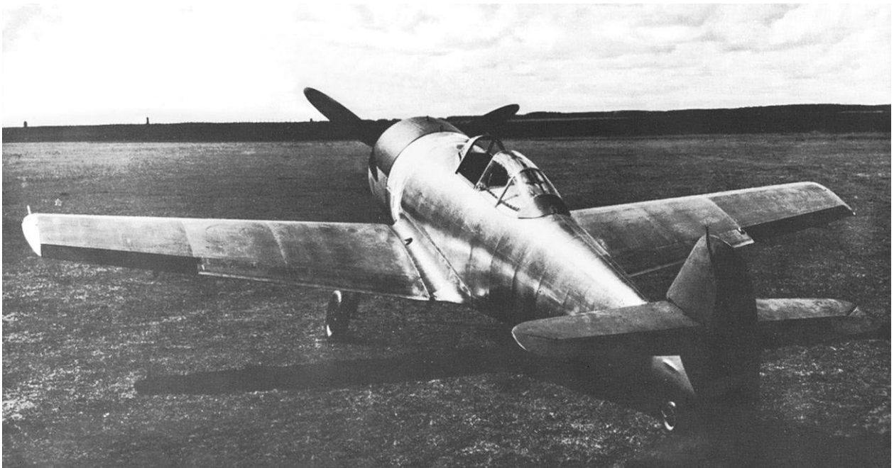
Die Bf 109 V21, ausgerüstet mit dem 14-Zylinder-Doppelsternmotor Pratt & Whitney R-1830 „Twin Wasp“. Dies ist das einzige bekannte Foto, welches eine Bf 109 mit Sternmotor vollständig zeigt. Die Motorverkleidung des P&W-Triebwerks ist vollkommen glatt – es fehlen die für den BMW 801 typischen seitlichen Ausbuchtungen (bedingt durch dessen innenliegende Ansaugschächte).
