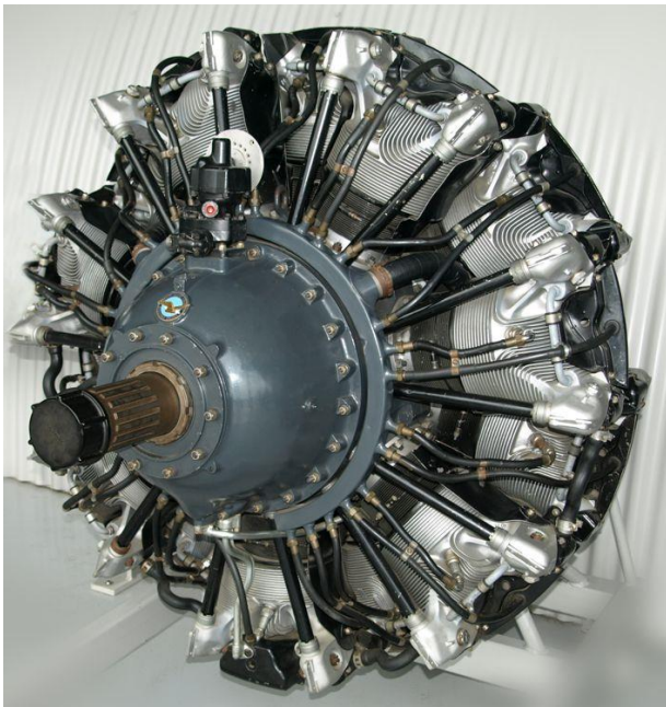
14-Zylinder-Doppelsternmotor Pratt & Whitney R-1830 „Twin Wasp“, wie er in die Bf 109 V21 eingebaut war. Seine Startleistung betrug rund 1.200 PS (882 kW).
