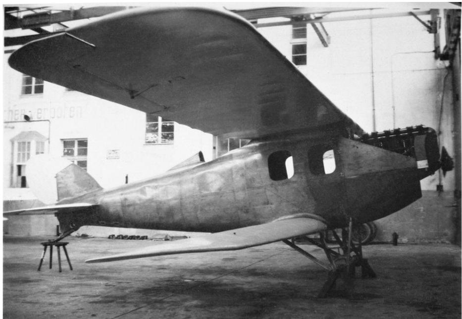
*Das Verkehrsflugzeug H.L.26 entstand als Umbau eines ehemaligen Militär-Doppeldeckers LVG C VI. Den offenen Pilotensitz hatte Hüffer nach hinten gerückt, davor befand sich eine geschlossene Kabine für drei Passagiere. Als diese Aufnahme entstand, waren die Stiele zwischen den Doppeldecker-Tragflächen noch nicht montiert. Die H.L.26 blieb unvollendet.*
