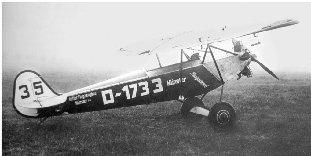
*Im Juni 1930 nahm die HB 28, inzwischen mit der Zulassung D-1733 versehen, am DLV-Zuverlässigkeitsflug teil. Pilot war Pol. Hptm. Otto Büter. Die Maschine besaß zu diesem Zeitpunkt einen Fünfzylinder-Sternmotor Siemens Sh 13 (68/80 PS, 50/59 kW).*
