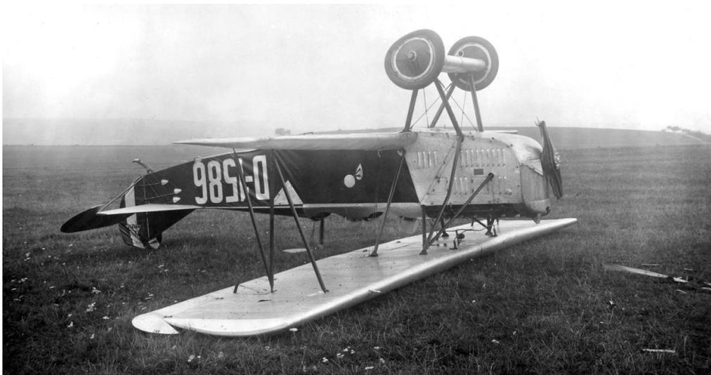
*Fahrwerksschaden mit anschließendem Überschlag bei der Deutschen Luftfahrt GmbH in Würzburg am 12.9.1930. Pilot war der Übungsschüler Karl-Heinrich Heyse.*
