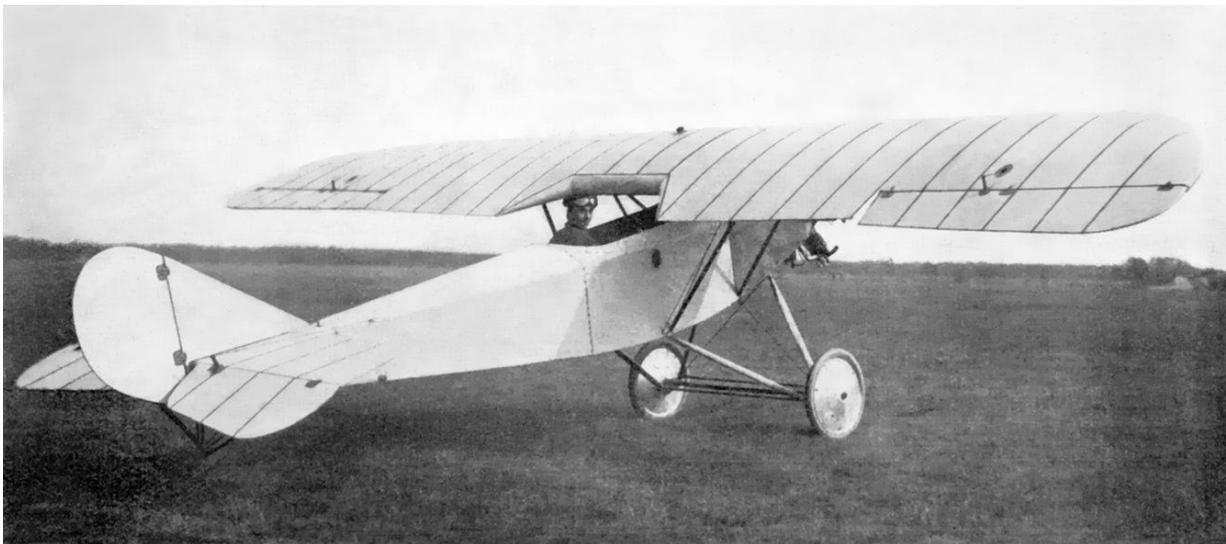
Alternativ zum Anzani konnte ein Fünfzylinder Siemens-Sternmotor Typ Sh 4 mit 55/60 PS (40/44 kW) Verwendung finden. Später sollte auch „der neue luftgekühlte 4-Zylinder Hüflug-Motor, welcher bei 1400 Umdrehungen 50-52 PS leistet“, eingebaut werden – wie es in einem Hüffer-Prospekt über die „Bajadere“ hieß. Ende 1923 befand sich dieser Motor angeblich schon in der Entwicklung, aber fertig wurde er offenbar nie.
