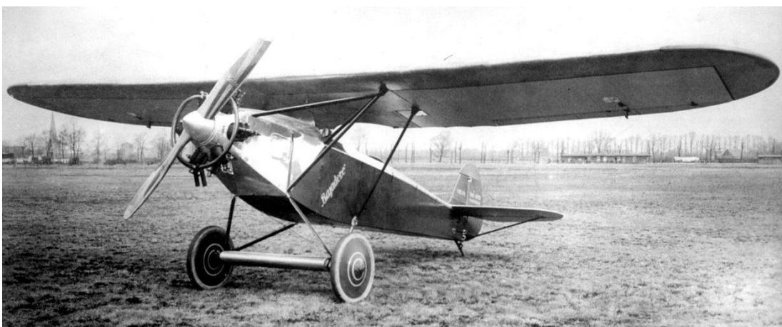
Neben dem Anzani-Motor wurden für den Einbau in die HB 28 auch der Vierzylinder-Boxermotor ABC „Hornet“ (75/82 PS, 55/60 kW) sowie die Fünfzylinder-Sternmotoren Armstrong-Siddeley „Genet II“ (80/88 PS, 59/65 kW) und Walter NZ 60 (60/70 PS, 44/51 kW) als geeignet angegeben.
