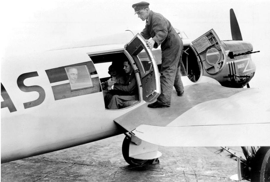
*Die spiegelnde Oberfläche des Flügels dieser He 70 D dokumentiert ihre extreme Oberflächengüte. Die D-UDAS eröffnete im Juni 1934 den Schnellverkehr auf den sogenannten Blitzstrecken, ging aber im Januar 1935 bei einem Unfall in der Nähe von Konstanz verloren.*
