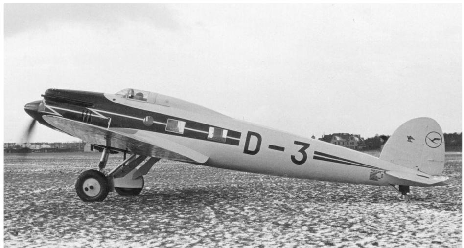
Bei der Musterprüfung Anfang 1933 in Staaken erreichte die He 70a (Werknr. 403), die dabei das vorläufige Kennzeichen D-3 trug, eine Maximalgeschwindigkeit von 362 km/h und danach, am 26. April 1933, sogar 377 km/h.
