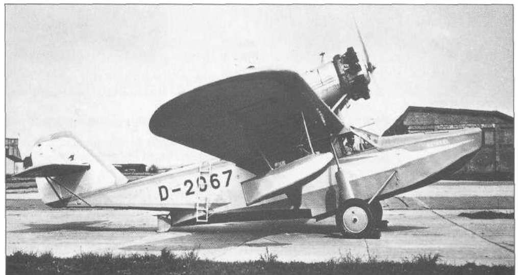
Die „Heron“ nach der Zulassung auf dem Flugplatz Warnemünde; der Rumpf ist umgebaut, statt des Spornrades hat der Wasserruder einen Schleifsporn
