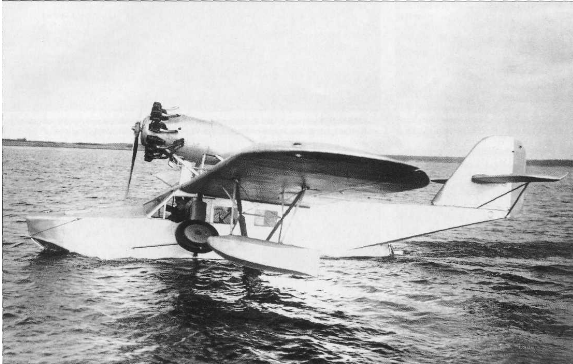
Die HE 57 in der zweiten Ausführung; deutlich zu sehen das hochgezogene Fahrwerk
