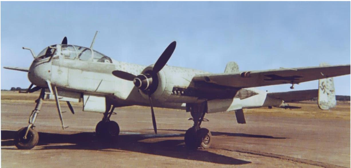
*Die He 219 A-2, Werknummer 290013, wurde in Rostock gebaut. Das Foto zeigt die Maschine kurz nach ihrer Fertigstellung auf dem Heinkel-Werkflugplatz Marienehe. Das Bordradar FuG 220 Lichtenstein SN 2 ist noch nicht eingebaut, wie die fehlenden Dipolantennen an den Bughalterungen zeigen.*
