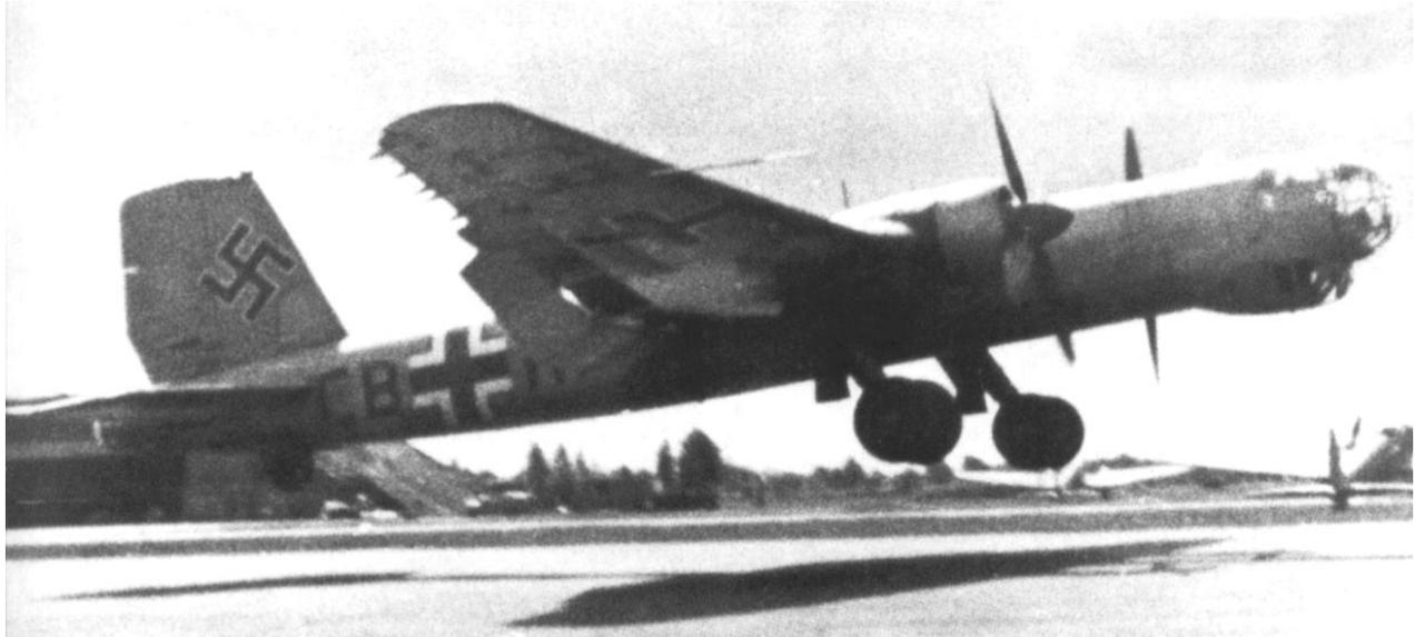
*Start der He 177 V1, CB+RP, zu einem Versuchsflug. Das vergrößerte Seitenruder im Vergleich zur Konfiguration während der Bodenerprobung ist klar erkennbar.*
