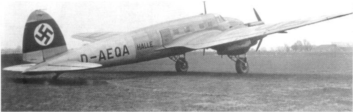
*Die erste der beiden in Rostock gebauten He 111 G (Wnr. 2534) trug bei der Lufthansa den Flottennamen „Halle“. Dieses Muster hatte zwar noch BMW VI-Motoren aber bereits den neuen Metallflügel mit gerader Vorderkante.*
