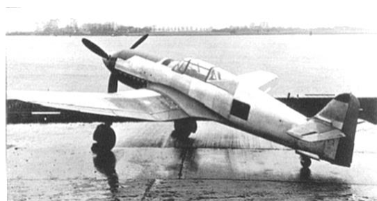
Das erste Versuchsmuster He 100 V-1 im „Urzustand“ unmittelbar nach der Fertigstellung, noch ohne Anstrich, ohne Rumpfrückenkondensator und mit kleinem Seitenleitwerk.
