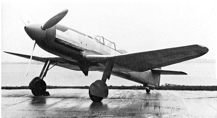
Das erste Versuchsmuster He 100 V-1 im „Urzustand“ unmittelbar nach der Fertigstellung, noch ohne Anstrich, ohne Rumpfrückenkondensator und mit kleinem Seitenleitwerk.
