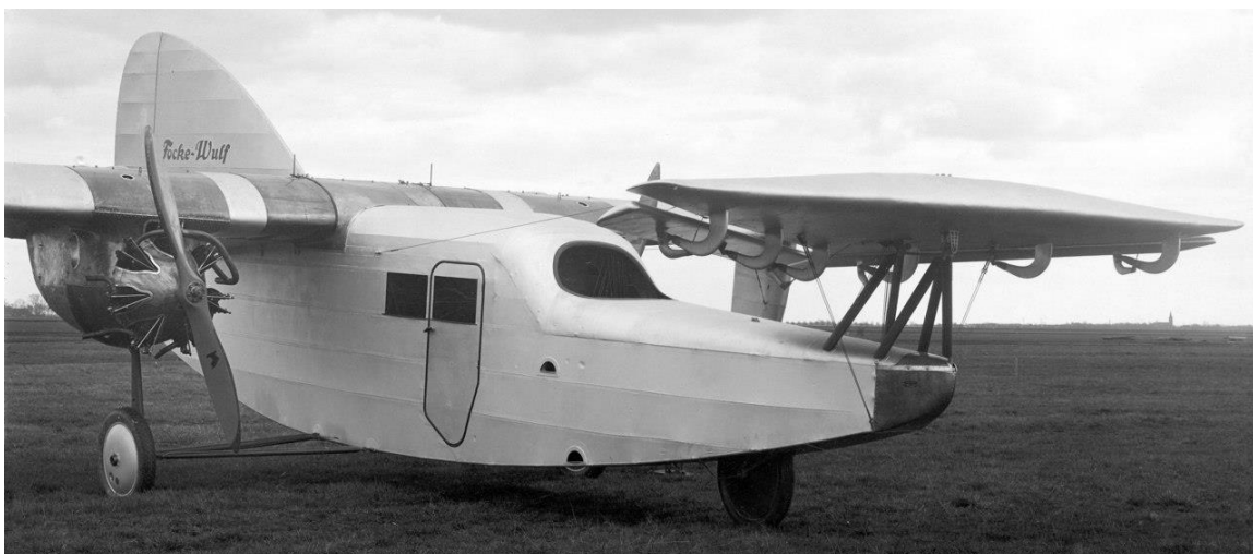
Die zweite „Ente“, bezeichnet als Focke-Wulf F 19 a, unterschied sich äußerlich von ihrer Vorgängerin nur durch den unverkleideten Strebenbock für das Höhenleitwerk und die zusätzlichen Seitenscheiben (Seitenflossen) unter dem Flügel.
