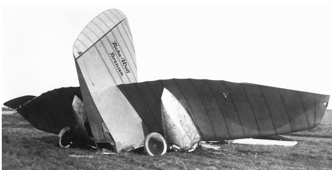
Absturz der F 19 am 29. September 1927 in Bremen bei der Vorführung des Austrimmens im Einmotorenflug. Pilot Georg Wulf erlitt dabei tödliche Verletzungen. (VFW Archiv)
