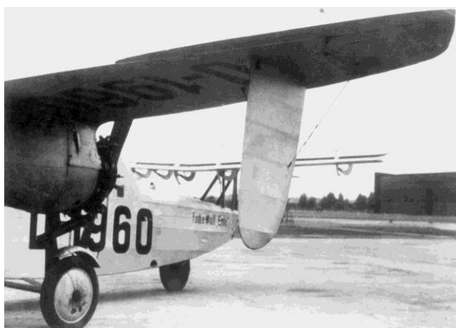
Systematische Versuche der DVL zeigten, daß die unter dem Flügel angebrachten Seitenscheiben im Normalflug nur eine ganz geringe Verbesserung der Stabilität um die Hochachse brachten. Im Horizontalflug war die Maschine ohne Seitenscheiben um 3 km/h schneller.
