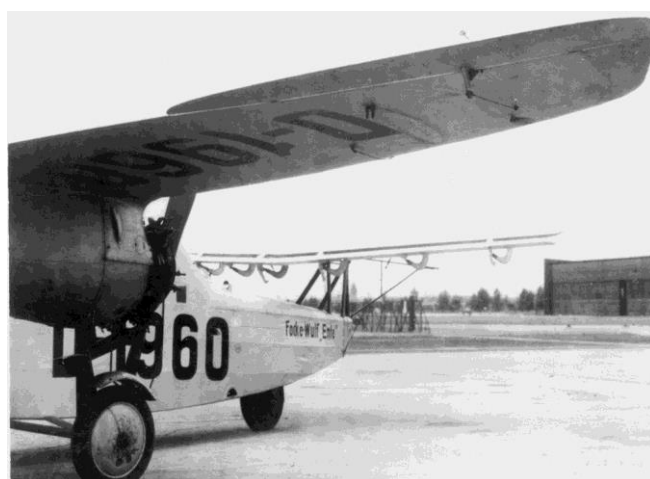
Systematische Versuche der DVL zeigten, daß die unter dem Flügel angebrachten Seitenscheiben im Normalflug nur eine ganz geringe Verbesserung der Stabilität um die Hochachse brachten. Im Horizontalflug war die Maschine ohne Seitenscheiben um 3 km/h schneller.
