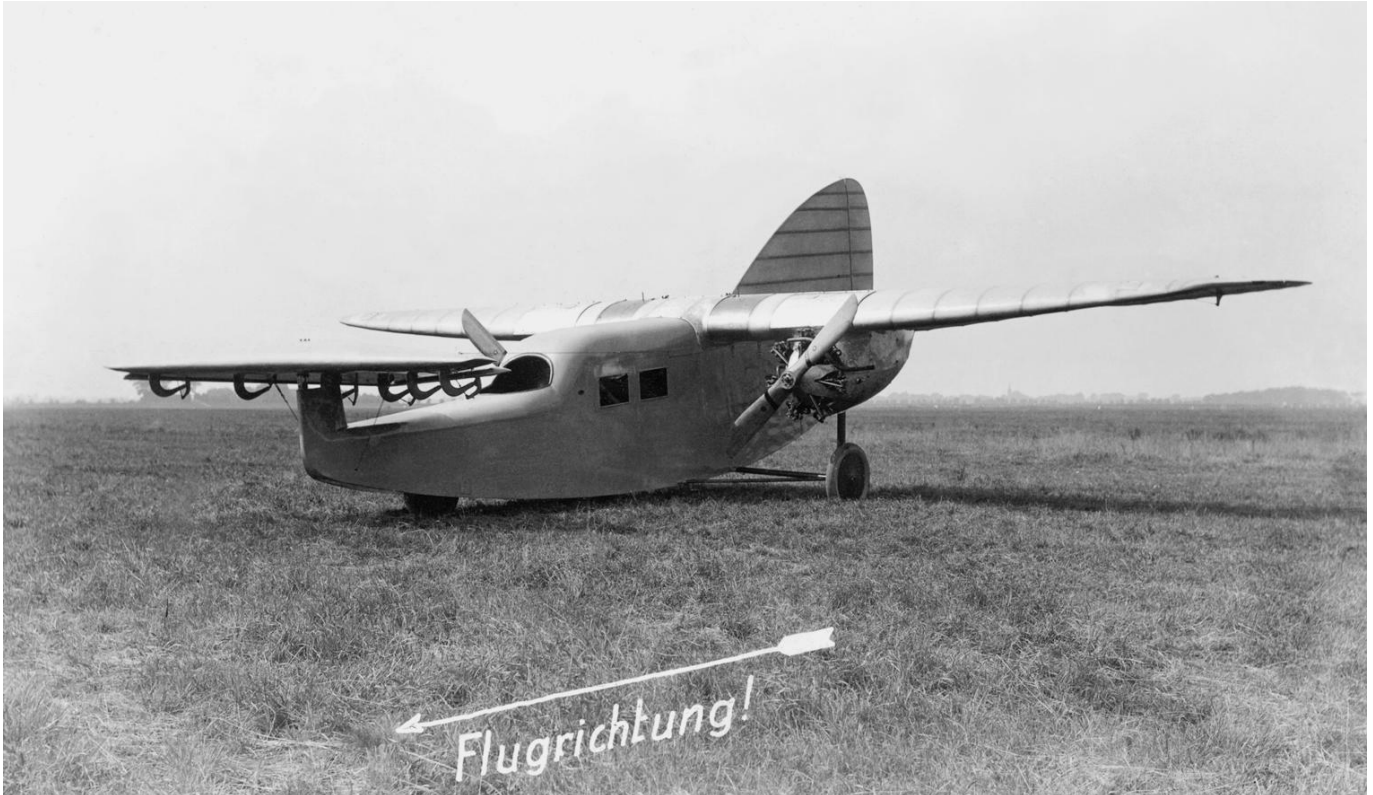
Das erste Muster der Focke-Wulf F 19 „Ente“ während der Erprobung auf dem Bremer Flugplatz Neuenland im September 1927. Zur Sicherheit hat die Presseabteilung des Werks die Flugrichtung der Maschine auf dem Foto markieren lassen, weil man davon ausging, daß nur einer Minderheit unter den Betrachtern klar war, daß sich das Höhenleitwerk eines Entenflugzeugs am Bug befand.
