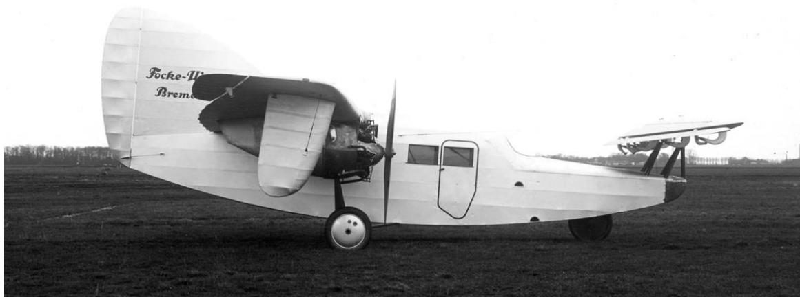
Gut zu erkennen sind auf diesem Foto die Seitenscheiben unter dem Flügel der F 19 a, mit denen die Kursstabilität gegenüber dem Ursprungsmuster verbessert werden sollte.
