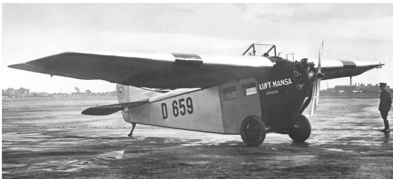
*Die Lufthansa-eigene D-659/WNr. 8 nach Umbau zur A 16 c im Streckendienst der DLH. Auffallend ist der große Über-schlagbügel, mit dem die Luft Hansa ihre A 16 ausrüstete, um die Piloten für den Fall der Fälle besser zu schützen.*
