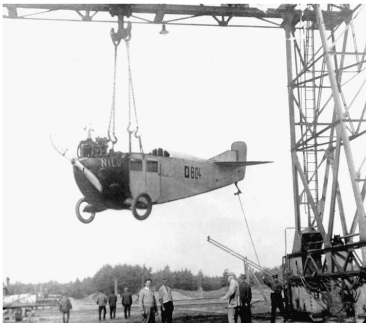
*Bahnverladung der A 16 d-Zelle D-804, das Tragdeck ist abgenommen und wird separat verstaут. Am Rumpfbug trägt die Maschine den Schriftzug „NILU“.*
