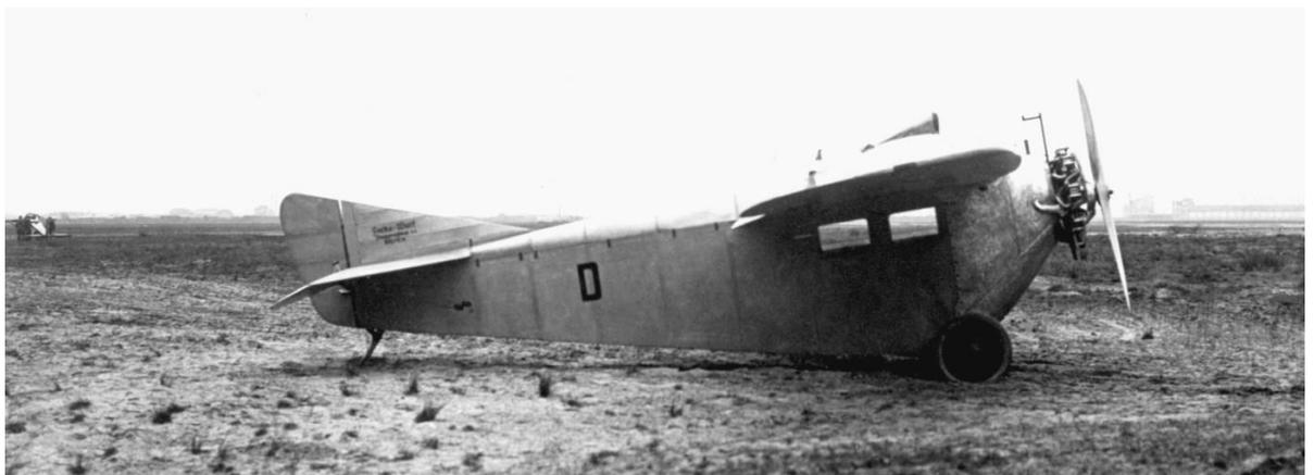
Die DAL-Werft Staaken begann schon im Dezember 1925, also vor dem Erstflug der Mustermaschine, die Aerolloyd-eigene A 16 D-467 (W.Nr. 3) zur Version A 16 c umzurüsten. Im Gegensatz zum Musterflugzeug erhielt die D-467 einen Siemens Sh 6 (W.Nr. 12431). Die späteren A 16 c-Umbauflugzeuge der DLH bekamen dann aber durchweg den verbesserten Sh 12. Der Erstflug der D-467 mit dem Neunzylinder-Triebwerk fand nicht vor Februar 1926 statt.
