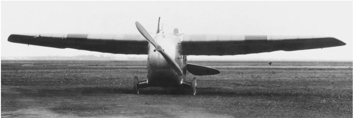
**(Bilder oben):** Im März 1925 kam die A 16 a mit 100 PS-Mercedes heraus. Pilot und Motor waren nebeneinander angeordnet, dazu hatte man das Triebwerk etwas aus der Mittelachse nach rechts versetzt. Die beiden Fotos zeigen die Mustermaschine WNr. 5 in ihrem ursprünglichen Zustand, das Seitenruder besitzt noch kein Ausgleichshorn.
