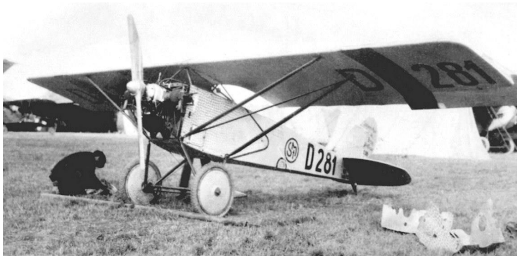
(links): Wartungsarbeiten an der R III 22 D-281 während der Internationalen Flugwettbewerbe in Göteborg. Die Verkleidungsbleche der Motorsektion sind abgenommen und neben der Maschine auf dem Rasen plaziert.
