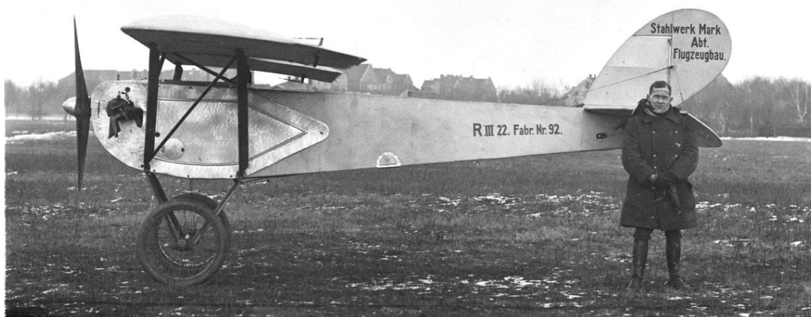
Werner Rieseler präsentiert die Mark R III 22, Fabriknummer 92 – eine der allerersten Serienmaschinen. Nach Demontage der Tragflügel ließ sich das Flugzeug z.B. von einem Motorrad „auf den Haken nehmen“.
