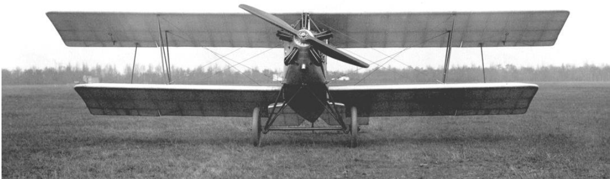
Das Schulflugzeug Mark MS 2 b, ausgerüstet mit dem Fünfzylinder-Sternmotor Mark St.M. 5 (55/63 PS), war der einzige Doppeldecker, den das Stahlwerk Mark herausbrachte. Die abgebildete Maschine mit der Werknummer 220 wurde später nach Polen verkauft.
