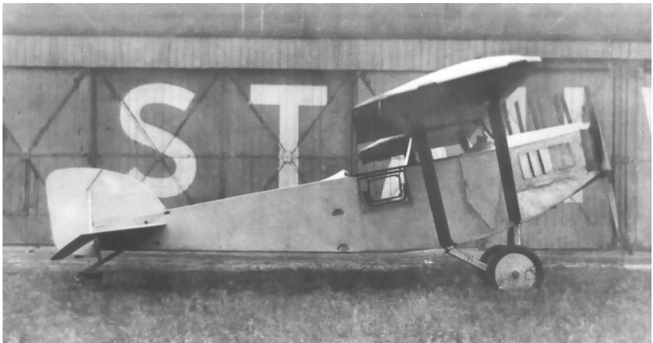
Das Luftbildflugzeug Mark ML 1 war aus dem Verkehrsflugzeug MV 1 „Görlitz“ abgeleitet. Interessant ist das hintenliegende Abteil des Foto-Operators mit den halbhoch ausgeschnittenen Rumpfsseiten und den davor befindlichen Sicherungsgittern aus Stahlrohr. (Slg. Dabrowski)
