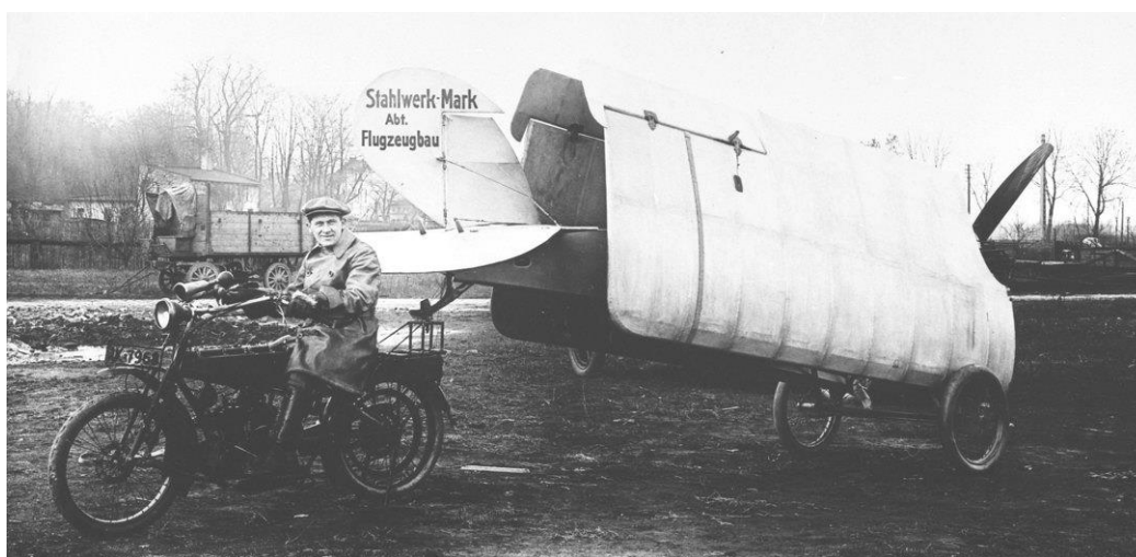
Werner Rieseler präsentiert die Mark R III 22, Fabriknummer 92 – eine der allerersten Serienmaschinen. Nach Demontage der Tragflügel ließ sich das Flugzeug z.B. von einem Motorrad „auf den Haken nehmen“.
