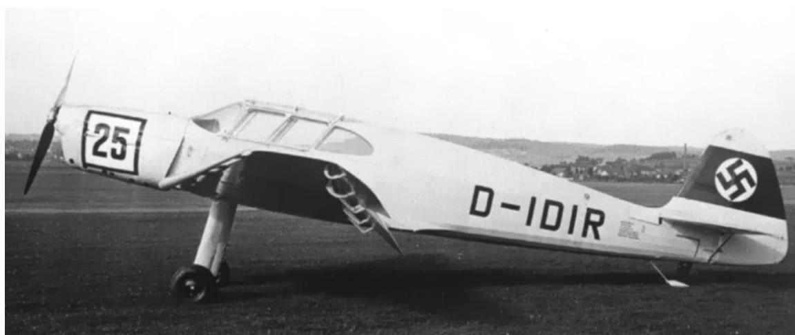
(oben): Klemm KL 36 in der Seitenansicht mit ausgefahrenen Vorflügeln und voll ausgeschlagenen Landeklappen. Dabei wurden die im Außenflügelbereich befindlichen Querruder automatisch um 15° nach unten gesenkt.
