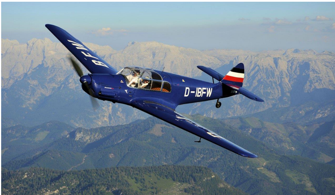
(oben): Die Me 108 wurde zum Vorbild aller eleganten und schnellen Reiseflugzeug-Tiefdecker mit bequemer, geschlossener Kabine und paarweise nebeneinander angeordneten Sitzen. (Slg. Rimensberger)
