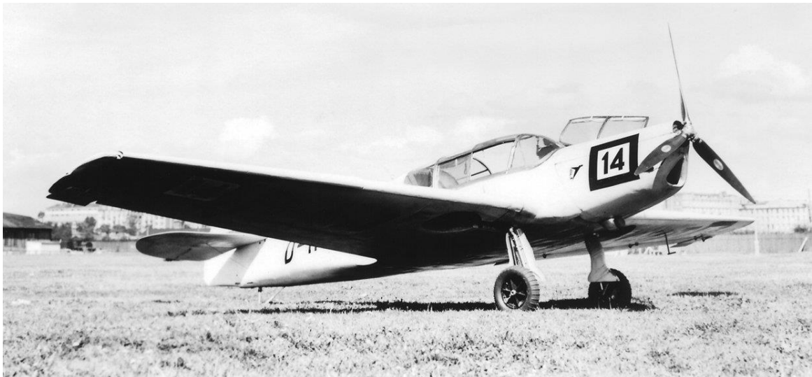
(oben): BFW Me 108 mit Achtzylinder-V-Motor Hirth HM 8U und Dreiblatt-Verstellpropeller. Die Startnummer 14, Kennzeichen D-IMUT, flog Theo Osterkamp im Wettbewerb. (Slg. Szigeti/DEHLA)
