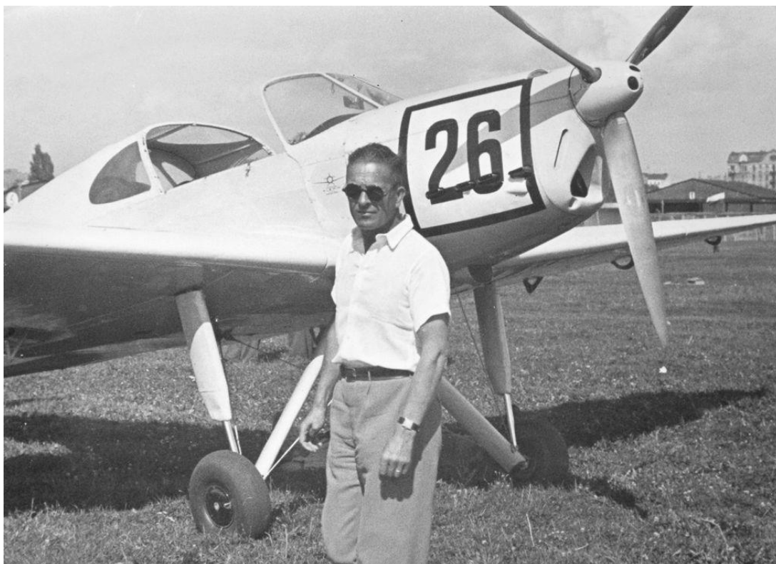
Aussehen der Klemm KL 36 mit Hirth HM 8U Achtzylinder-V-Motor. Die abgebildete Startnummer 26 (Zulassung D-IBAV) wurde im Wettbewerb von dem vor der Maschine stehenden Fritz Morzik geflogen. (Knoblich, Slg. Klemm)
