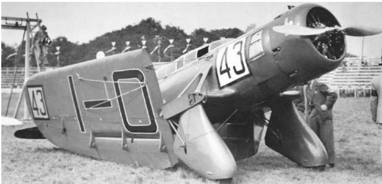
Bei der italienischen Breda 42, hier die Maschine I-OMBO (43) von Piero de Angeli, konnten die Flügel zum Abrüsten um eine hintenliegende Achse gedreht und an den Rumpfgeklappt werden, ohne die oberen Verspannungsdrähte zu lösen.
