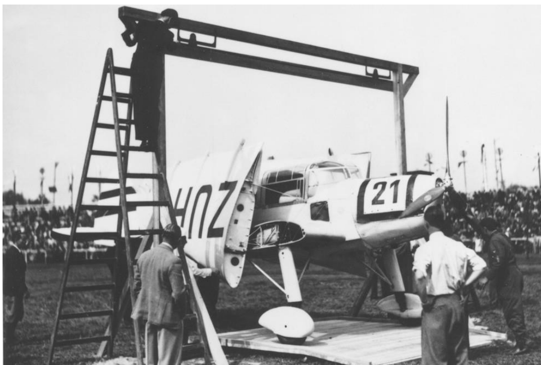
Bei den deutschen Tiefdeckern mußten die Tragflächen um zwei Achsen gedreht werden, damit die abgerüstete Zelle durch das Meßtor paßte – und das brachte nur halb soviel Punkte im Vergleich zu den polnischen RWD-9. Im Foto ist die Fi 97 von Gerhard Hubrich zu sehen (D-IZUH, Startnr. 21)
