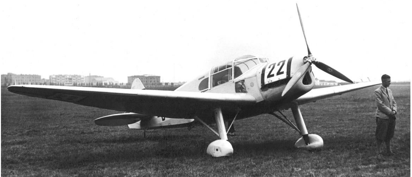
(oben): Fi 97 mit Hirth HM 8U Achtzylinder-V-Motor (Zulassung D-IDA H, Startnummer 22) (Archiv NAC) (unten): Fi 97 mit Argus As 17 A Sechszylinder-Reihenmotor (Zulassung D-IBYR, Startnummer 18)
