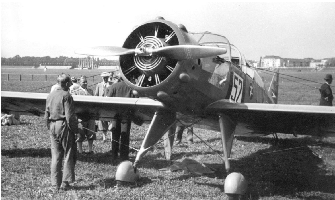
Der Tscheche Ján Ambruš landete als fünfter Teilnehmer in Prag. Seine Aero A 200, OK-AMB (52), war mit einem Walter „Bora“-Sternmotor ausgerüstet. Im Gegensatz zu den anderen Tiefdeckern, die am Wettbewerb teilnahmen, war die tschechische Maschine nicht freitragend ausgelegt sondern hatte verspannte Flügel.
