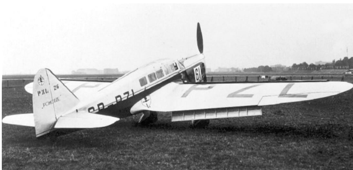
Interessante Ansichten der Langsamflughilfen, bestehend aus beweglichen Schlitzflügeln Bauart Handley Page-Lachmann und Spreizklappen unter den Innenflügeln, an der polnischen PZL 26. Hier die SP-PZL mit der Startnummer 61, geflogen von Piotr Dudziński.
