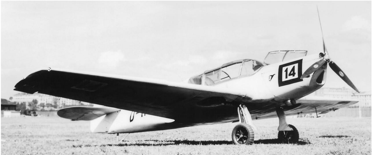
In der Benzinverbrauchsprüfung fiel das gute Abschneiden des Musters BFW Me 108 auf, sie belegten mit deutlichem Abstand die Plätze eins bis drei. Offenbar machte sich hier das Einziehfahrwerk der Messerschmitt-Maschine recht positiv bemerkbar.
