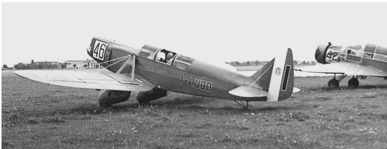
(oben): Der Italiener Ernesto Sanzin hatte nicht in Algier sondern in Sidi-Bel-Abbes übernachtet und hatte am 11.9. einen weiteren Weg bis Tunis. An seiner Breda 39 S, I-LUDO (46) ist der verstreute und verspannte Tiefdeckerflügel gut erkennbar. (Slg. Ott/ADL)
