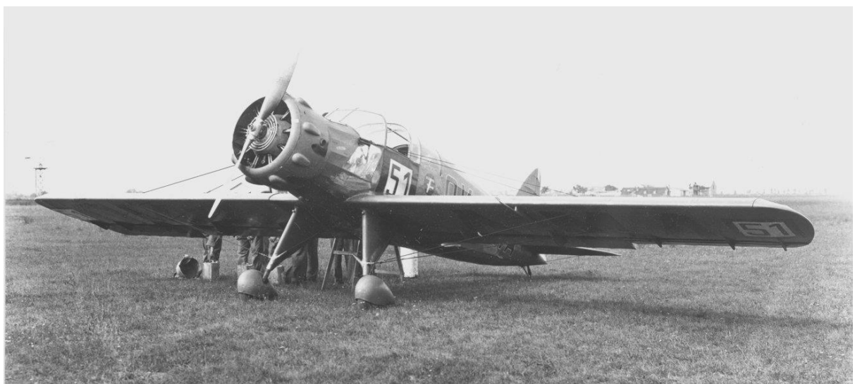
In der Aero A 200, OK-AMA (51), saß Vojtěch Žáček am Steuer. Seine Maschine war mit einem Walter „Bora“-Sternmotor ausgerüstet. Im Gegensatz zu den deutschen und polnischen Tiefdeckern war die tschechische Maschine nicht freitragend ausgelegt sondern hatte verspannte Flügel.
