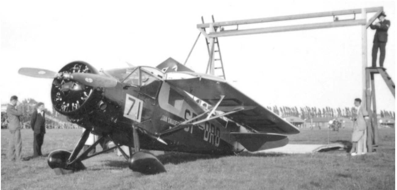
Alle polnischen RWD-9 Doppeldecker erreichten beim Ab- und Aufrüsten die Höchstpunktzahl, nicht zuletzt weil ihre Flügel beim Abrüsten nur um eine Achse gedreht zu werden brauchten, um am Rumpf anzuliegen. (Slg. Ott/ADL)
