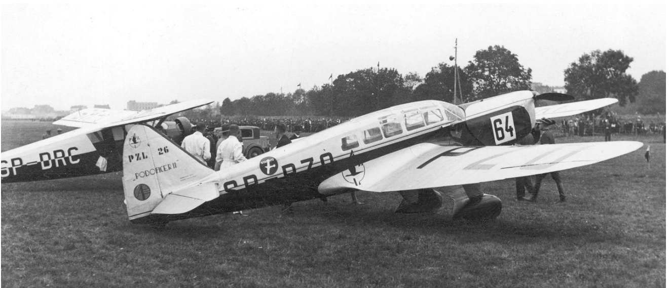
Auch der Pole Jan Balcer schied mit seiner PZL 26 (Startnummer 64, Kennzeichen SP-PZO) auf der letzten Etappe Prag – Warschau aus. Achillesferse aller Maschinen dieses Typs war der amerikanische Menasco-Motor, der sich von mangelhafter Konstruktion erwies und sehr unzuverlässig war. (Archiv NAC)
