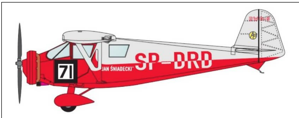
(unten): Die RWD-9 gehörte zur Familie des bequemen Reise-Schulterdeckers, ebenfalls ausgestattet mit zwei nebeneinander angeordneten Sitzen in geschlossener Kabine. Diese Linie kam Ende der 1920er Jahre in USA auf und faßte in Europa schnell Fuß. Nach dem 2. Weltkrieg verfolgten Cessna und Piper dieses Bauprinzip sehr erfolgreich weiter.
