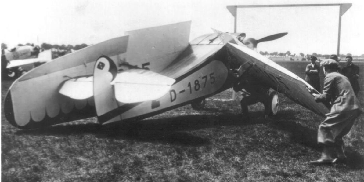
Bei der BFW M 23 c konnten zum Abrüsten die beiden Flügelhälften nach Lösen des unteren Hauptholm- und des Hilfsholmbeschlages jeweils um den oberen Hauptholmbeschlag gedreht und dann an den Rumpf angeklappt werden.
