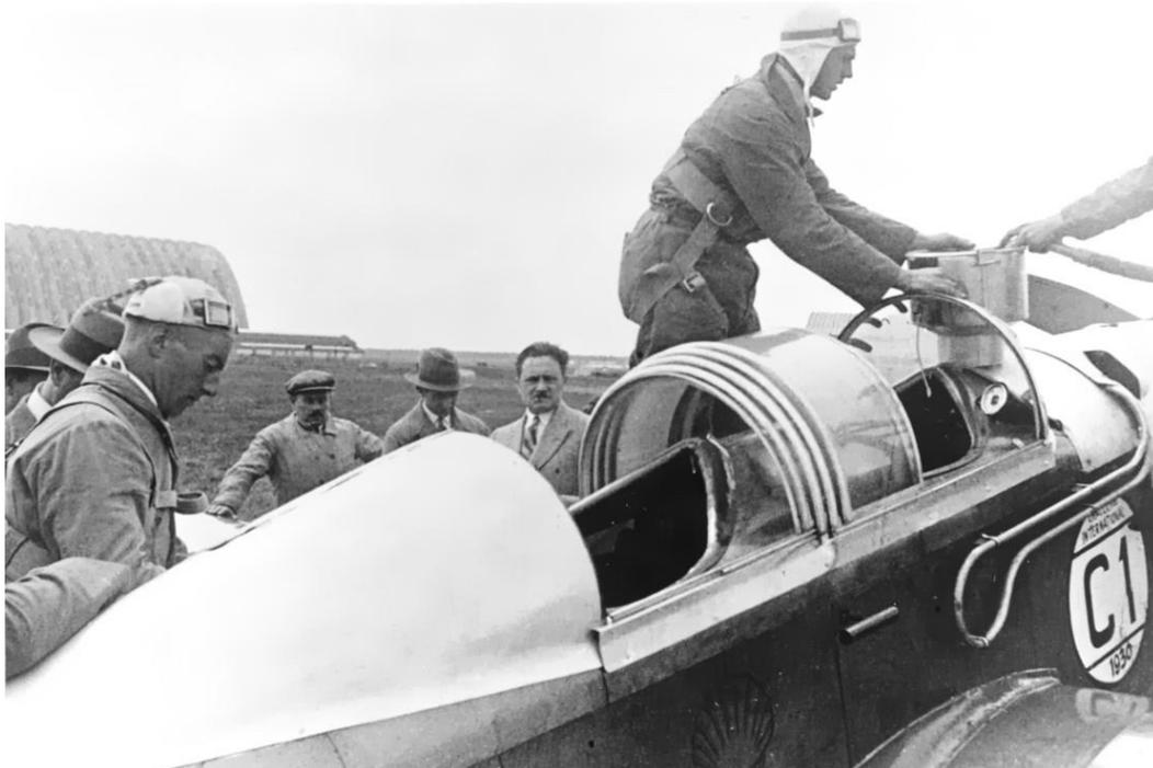
*Auch die Klemm L 25 E schnitt bei der Ausrüstungs- und Ausstattungsprüfung nur mittelmäßig ab, aus den gleichen Gründen wie die BFW M 23. Die verschiebbaren Segmente der Kabinenhaube wirkten noch improvisierter auf der Rumpfoberseite angebracht als die Kabinenabdeckung bei der M 23.*
