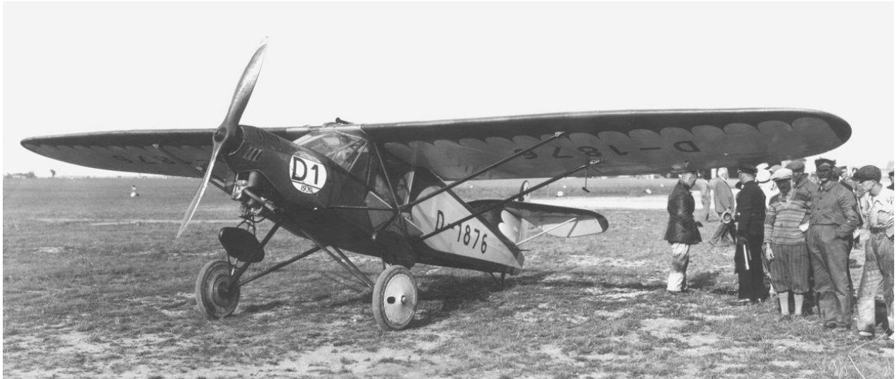
*Der Schulterdecker Arado L II a stellte eine leicht überarbeitete Version des Typs Arado L II „Treff Ass“ aus dem Jahr 1929 dar. Während die L II einen freitragenden Flügel besaß, hatte die L II a abgestrebte Flügel, die bei Bedarf an den Rumpf beige-
