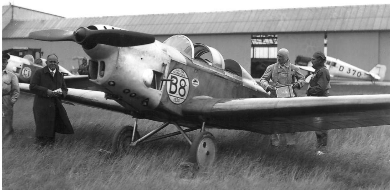
*Speziell für den Europa-Wettbewerb schuf die Firma Klemm aus dem Typ L 25 a das Muster L 25 E (E = Europarundflug). Abgesehen von einer verkürzten Flügelspannweite besaß die neue Maschine einen luftgekühlten Vierzylinder-Reihenmotor Argus As 8 und eine Kabinenhaube, die aus fünf halbrunden, in Rumpflängsrichtung ineinanderschließbaren Fensterelementen bestand.*
