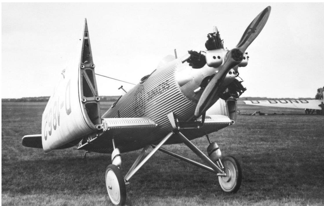
Auch die Außenflügel der Junkers A 50 c, die mit jeweils vier Kugelverschraubungen am Flügelmittelstück angeschlossen waren, ließen sich, wenn man diese Verbindungen gelöst hatte, um die horizontale Achse drehen und zugleich um die Vertikalachse nach hinten schwenken.
