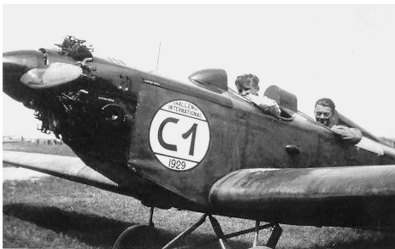
*Die Klemm L 25 I a von Wolf Hirth (D-1663, Startnummer C1) besaß gegenüber den serienüblichen Maschinen einige auffallende Änderungen: Der Propeller trug einen großen strömungsgünstigen Spinner, die Motorverkleidung war entsprechend angepaßt und beide Sitze hatten auf der Rumpfoberseite angebrachte hohe Kopfstützen.*
