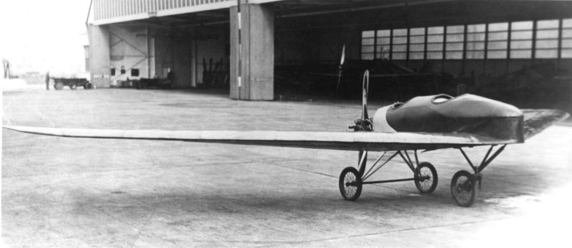
*Die Soldenhoff LF 6, ein schwanzloser Tiefdecker mit Pfeilflügeln, wurde nicht realisiert, es existieren auch keine Zeichnungen mehr. Die Maschine ähnelte dem hier abgebildeten Vorgängermuster LF 5, sollte aber eine verstärkte Zelle und einen stärkeren Motor erhalten.*
