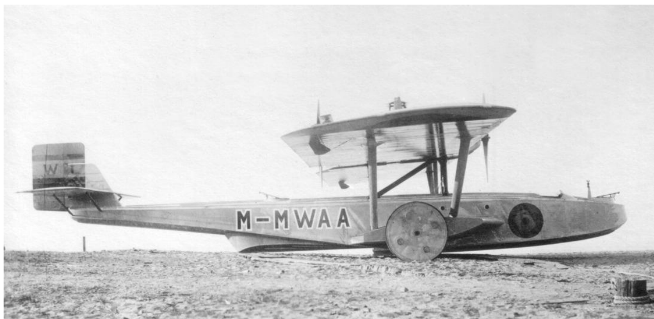
Für das Bewegen des „Wals“ an Land bot Dornier große, aus Blech gefertigte Hohlräder an, die im Wasser schwimmfähig waren. Ihre Steckachsen paßten in entsprechende Aufnahmehöhlen in den Flossenstummel-Seiten. Die Räder konnten im Wasser von einem Boot aus angebracht werden und ermöglichten es dem „Wal“, aus eigener Kraft an Land zu rollen. (Archiv Zeppelin-Museum Friedrichshafen)
