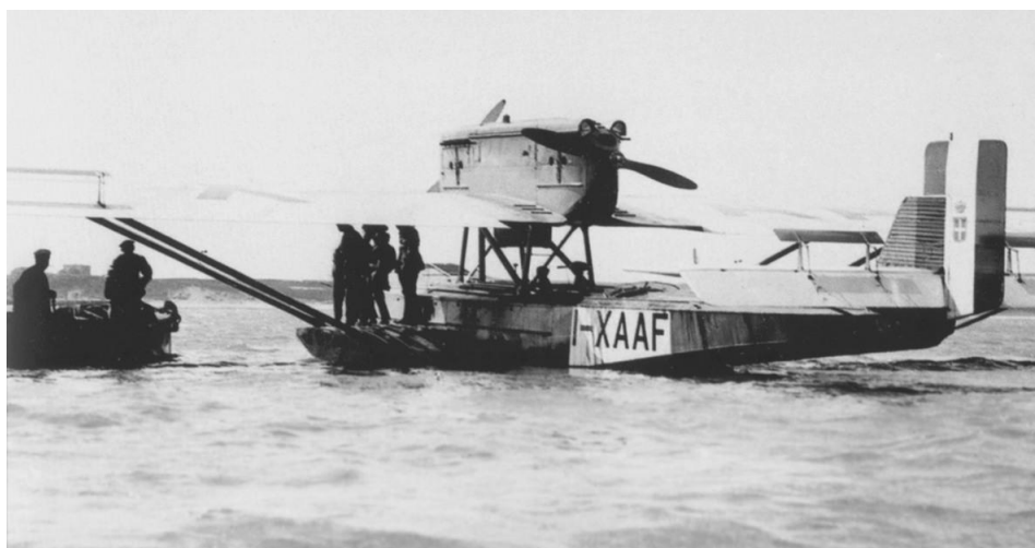
(oben + links): Die italienischen Marineflieger verfügten über 2 Dornier „Wale“. Die in den beiden Bildern gezeigte I-XAAF „Marina I“ trug die Werknummer 65 und war mit Isotta-Fraschini „Asso“-Motoren ausgerüstet. Für den Einsatz bei der Nobile-Suchexpedition in der Arktis im Sommer 1928 wurde der Führerstand des Flugboots mit einer geschlossenen, teilverglasteten Haube versehen. Die Maschine ging später an die Regia Aeronautica (italienische Luftwaffe).
