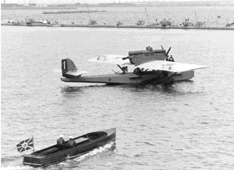
Dornier „Wal“ mit dem taktischen Kennzeichen Nr. 1 der sowjetischen Schwarzmeer-Flotte, aufgenommen vermutlich im Hafen Sewastopol. Die an Rußland gelieferten Militärwale waren alle mit dem BMW VI-Motor ausgerüstet, später auch mit dem sowjetischen Lizenznachbau M 17.
