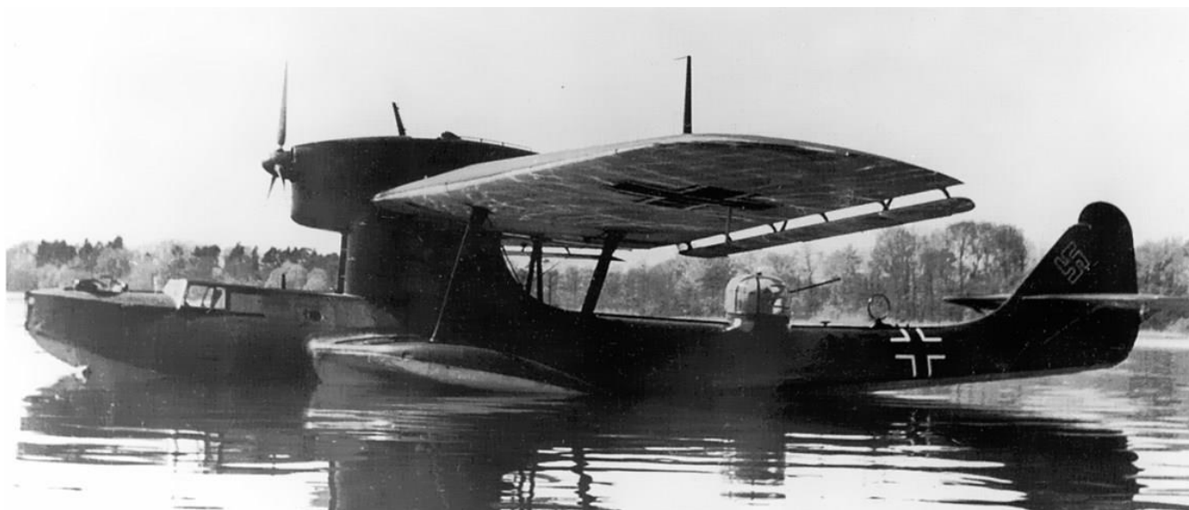
Eine Do 18 D, bereits mit Kreuzerbug aber noch ohne verbreiterte Flossenstummel, nach Umbau des B-Standes auf HDL 151/1 mit MG 151/20.
