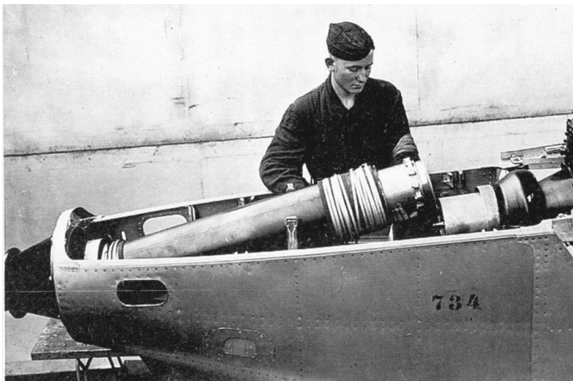
(unten): Wechsel der Fernantriebswelle am hinteren Motor der Do 18 L.
