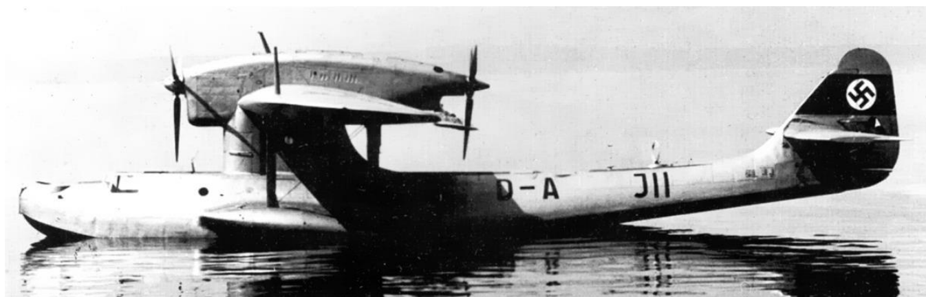
Die D-AJII war das Musterflugzeug der sieben Flugzeuge umfassenden D-0 Serie. Im Gegensatz zu den E-Flugzeugen münden die Abgasrohre nicht mehr direkt ins Freie. Innerhalb des Kennzeichens ist Platz für das später einzusetzende Balkenkreuz gelassen.
