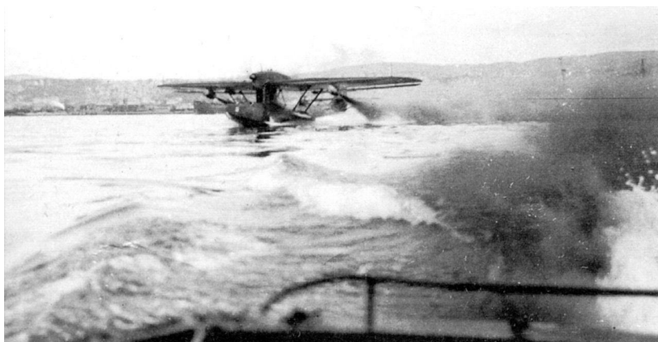
Ein seltenes Bilddokument: Eine Do 18 D startet mit Hilfe von 2x500 kg Rauchgeräten, sogenannten „Krafteiern“. (Slg. Petrick)
