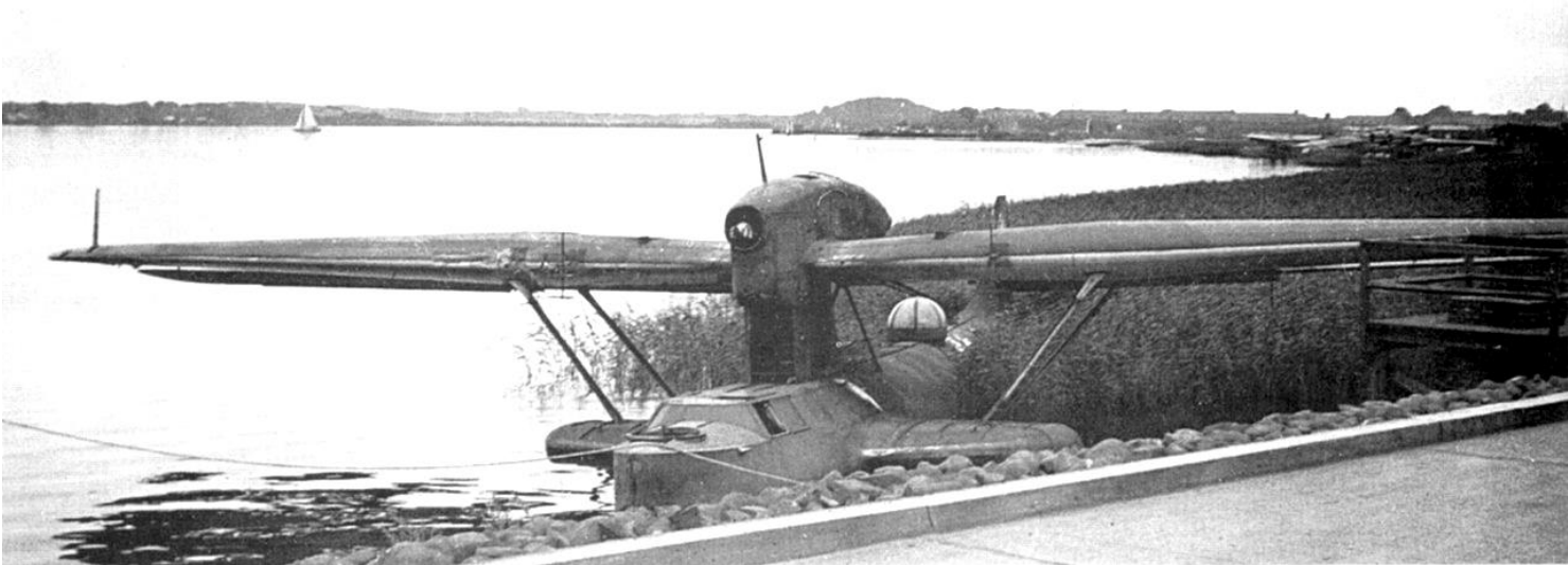
Eine Do 18 G in Schleswig, Juni 1945. Es ist eines der wenigen mit FuG 200 „Hohentwiel“ zur Schiffssuche ausgerüsteten Flugzeuge dieses Musters, die in der Ostsee Jagd auf sowjetische U-Boote machen sollten. Die Antennen sind an den Flügelnasen jeweils etwa 80 cm von den Flügelstielen nach innen befestigt. Im Hintergrund sind Do 24 und He 115 zu erkennen. (Foto: Björn Halgrimson)
