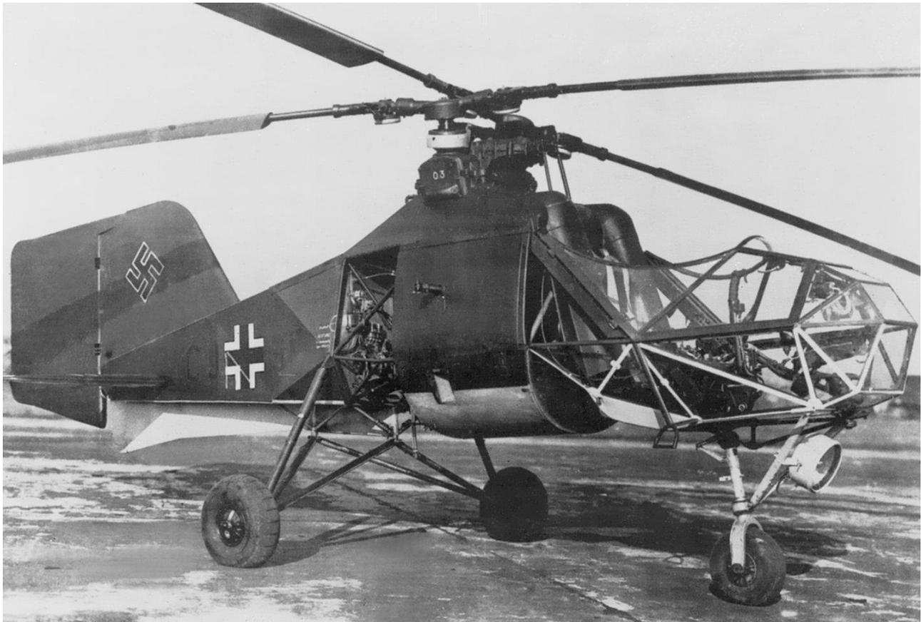
*Der Fl 282 V12, Stammkennzeichen CJ+SF, war mit einer zweidrittelhohen Glasverkleidung des Führerraums im Rumpfbug versehen. Alle gebauten Maschinen trugen nummerierte Getriebegehäusedeckel, hier die Nummer 03.*
