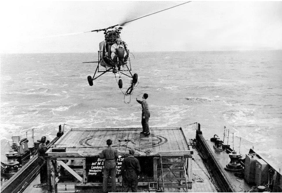
Ab August 1942 fanden in der Lübecker Bucht auf dem Flug-sicherungsschiff „GREIF“ der E-Stelle Travemünde die ersten Deckslande-Versuche mit Fl 282 statt. Als Lande- und Startort diente eine hölzerne Plattform, die auf dem flachen Heck der „GREIF“ fest verankert war. Zum Einsatz kamen die Maschinen Fl 282 V5, GF+YE, und V6, GF+YF.
