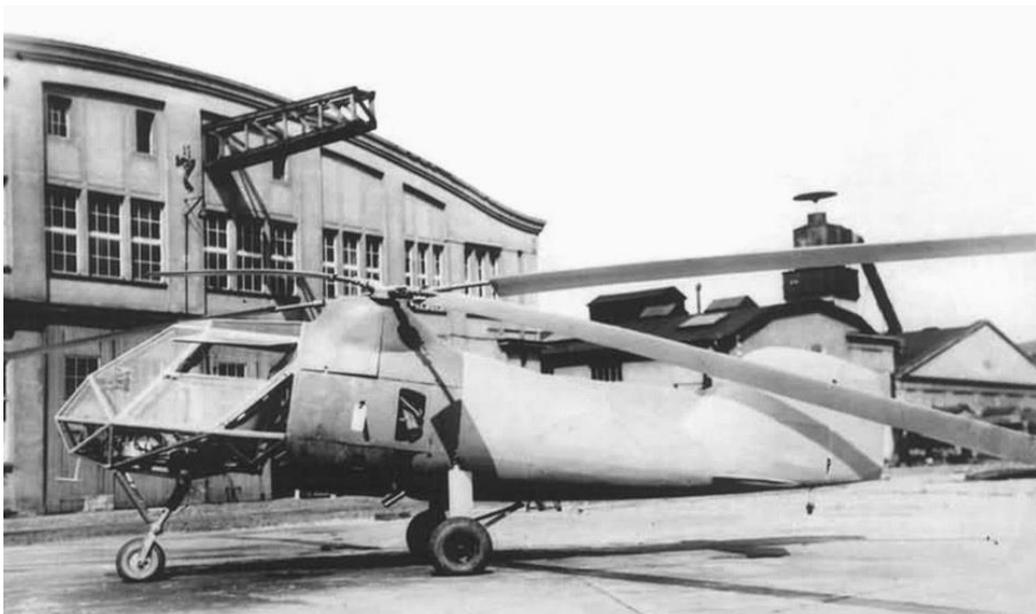
Bei der Fl 282 V3 war der Führerstand nur in einem schmalen Frontbereich verglast. Die Maschine trug Endscheiben an der Höhenflosse und hatte das Stammkennzeichen GF+YC.
