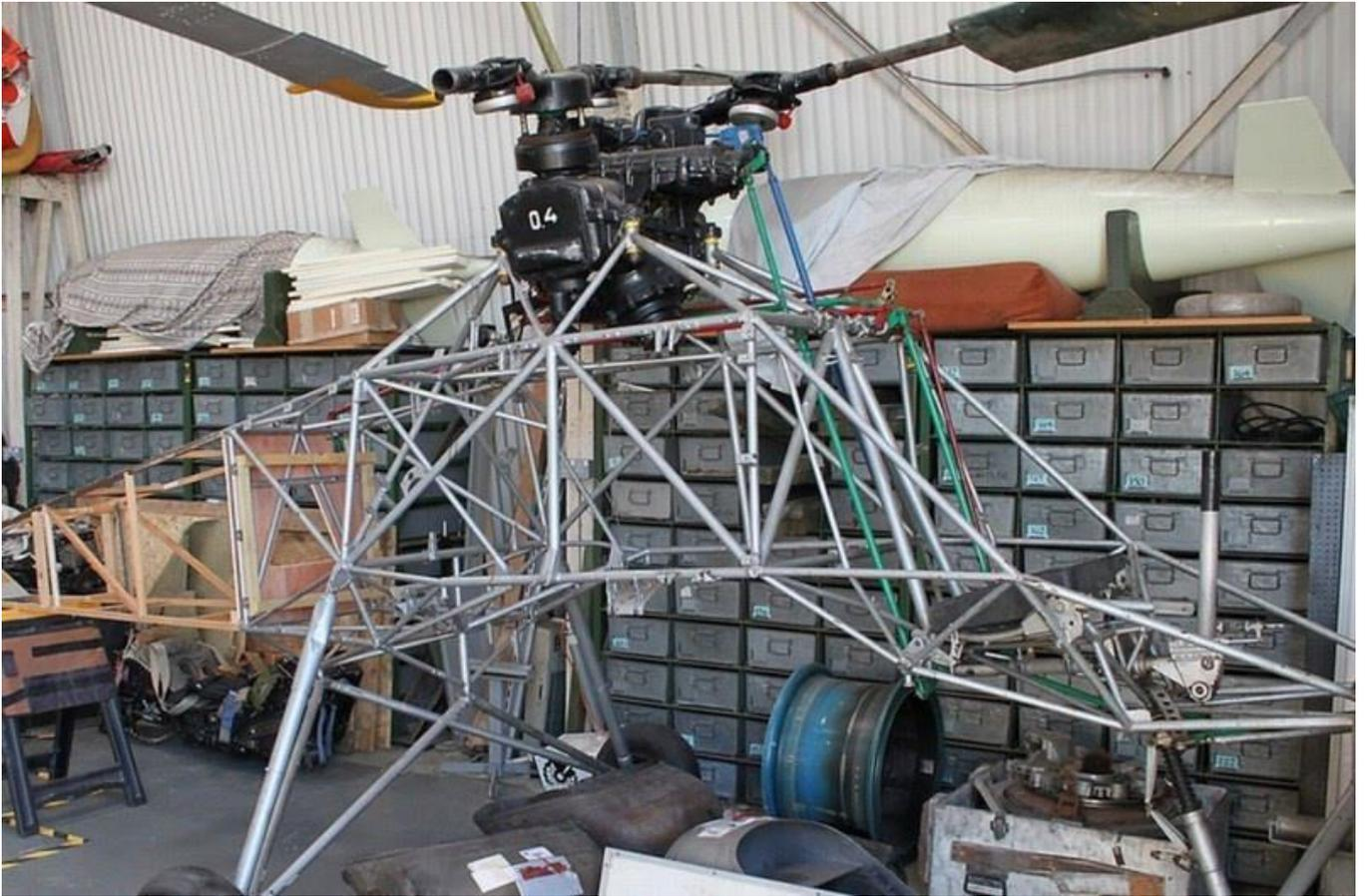
*Restaurierung des Rumpffachwerks der Fl 282 V20, Einbau des überholten Rotorgetriebes mit der Nummer 0.4 und Ergänzung des fehlenden Rumpfhecks – ausgeführt vom Midland Air Museum in Coventry.*
