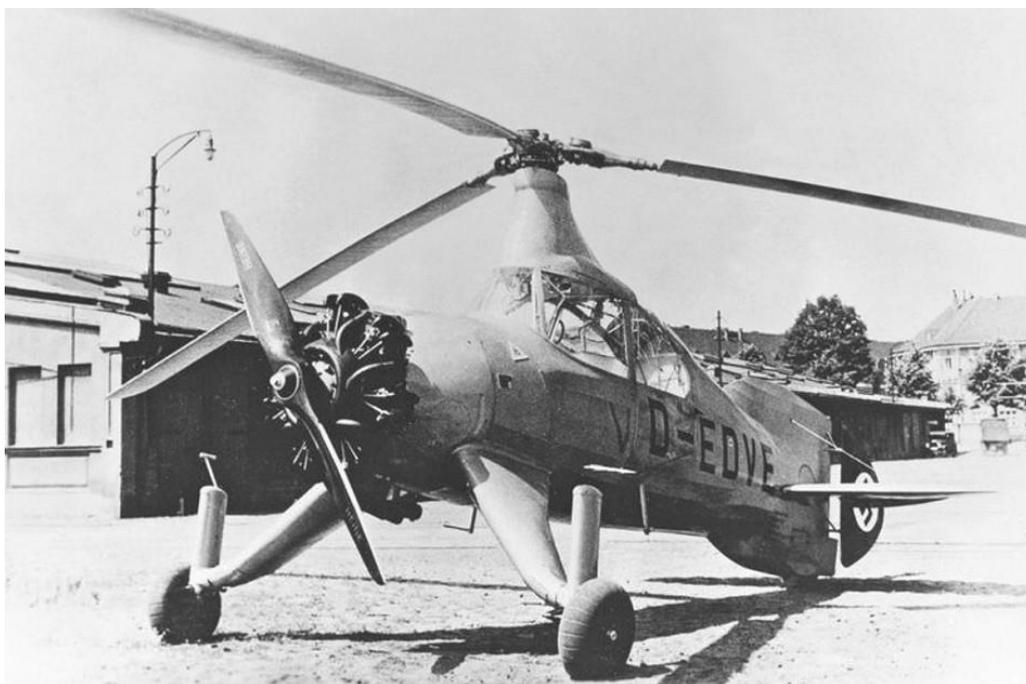
*Tragschrauber Fl 184 V1, Kennzeichen D-EDVE. Für den Vortrieb sorgte ein Siemens SAM 14 A-Sternmotor (145/160 PS) mit normalem Propeller.*
