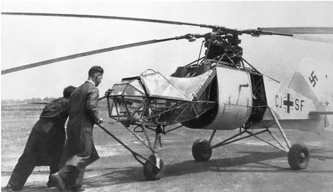
Die Fl 282 V12, Stammkennzeichen CJ+SF, beim Rangieren durch 2 „MS“. Rollen mit eigener Kraft war bei dem Flettner-Hubschrauber grundsätzlich untersagt. Der Führerraum war mit einer zweidrittelhohen Glasverkleidung versehen und erlaubte eine gute Sicht in alle Richtungen – mit Ausnahme nach rückwärts.
