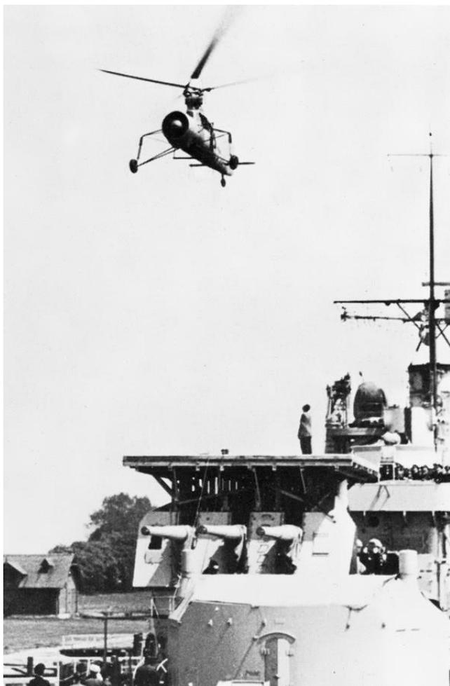
*Einsatzerprobung der Fl 265, Stammkennzeichen GI+SA, auf dem Leichten Kreuzer „Köln“. Für die Ausführung von Schiffslandungen war im hinteren Rumpfbereich des Kreuzers auf dem zweiten (erhöhten) Drillingsturm eine Plattform aus Holz von 5x5 m errichtet worden.*
