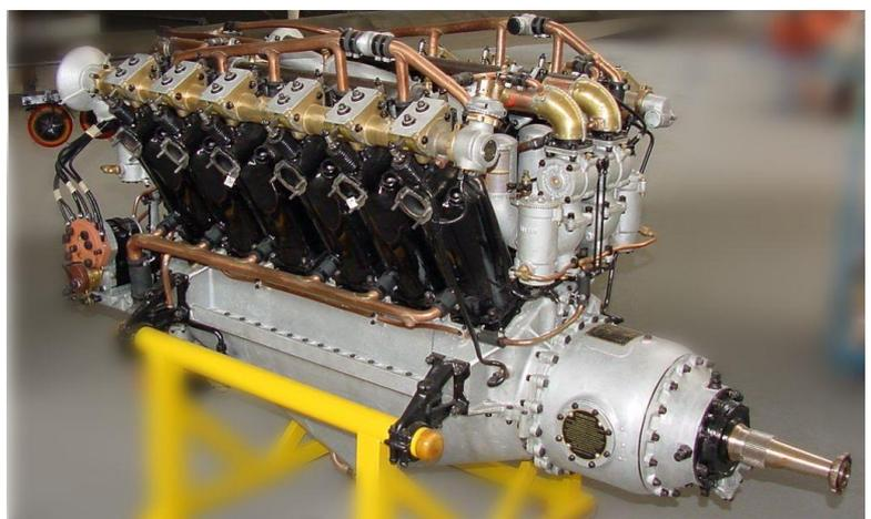
Das Standardtriebwerk der „Komet I“ war der Sechszylinder-BMW IIIa (links), während die „Komet II“ überwiegend mit dem Zwölfzylinder-Rolls-Royce „Falcon III“ ausgerüstet war (rechts).
