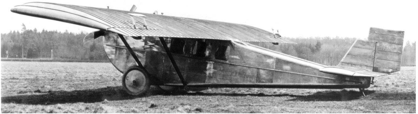
*Dieses Bild läßt gut die auf den Querrudern der „Komet“ angeordneten Hilfsflügel erkennen, die zur aerodynamischen Entlastung der Ruder und damit zur Reduzierung der Ruderkräfte dienen.*
