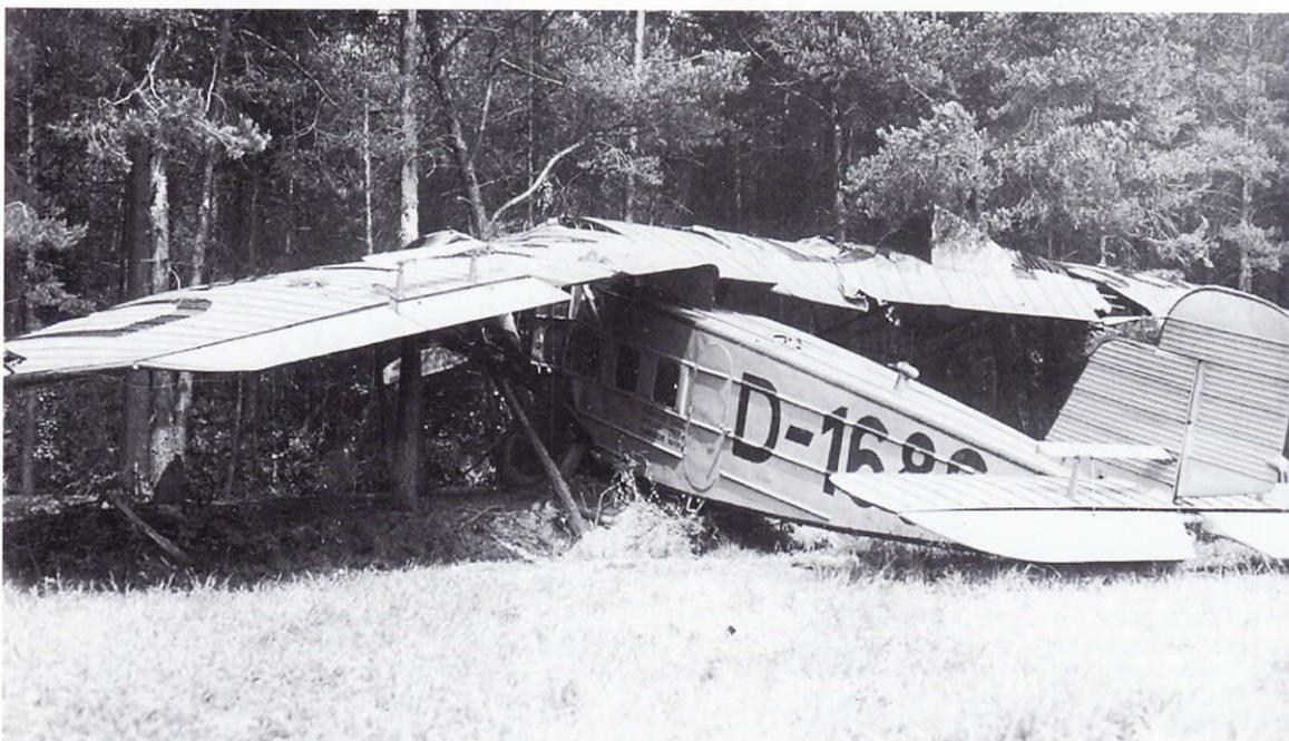
Am 13. Juni 1930 mußte der D-1686 "Mungo" in der Nähe von Gütersloh wegen Triebwerkschadens notlanden und kam ohne Radbremsen nur unsanft zum Stillstand. Die Insassen blieben unverletzt, doch war das Flugzeug bei einer Schadenshöhe von 67% schrottreif.
