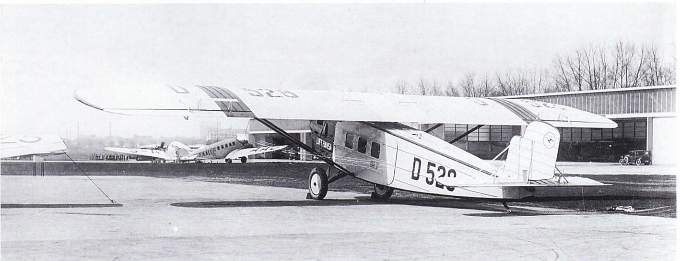
Der Do B Ral Komet III D-528 "Luchs" - hier in Berlin-Tempelhof - überflog am 15 April 1925 als erstes Verkehrsflugzeug die Alpen. Zwei Merkmale des Komet III sind gut zu erkennen: durchgehende Tragflächenhinterkante und abgestrebttes Leitwerk.
