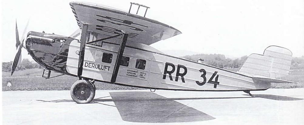
**Der Do B Bal 2 RR 34 der Deruluft mit BMW V1u-Getriebemotor und geschlossenem Führerstand kam als D-1605 "Kreuzfuchs" zur Luft Hansa.**
