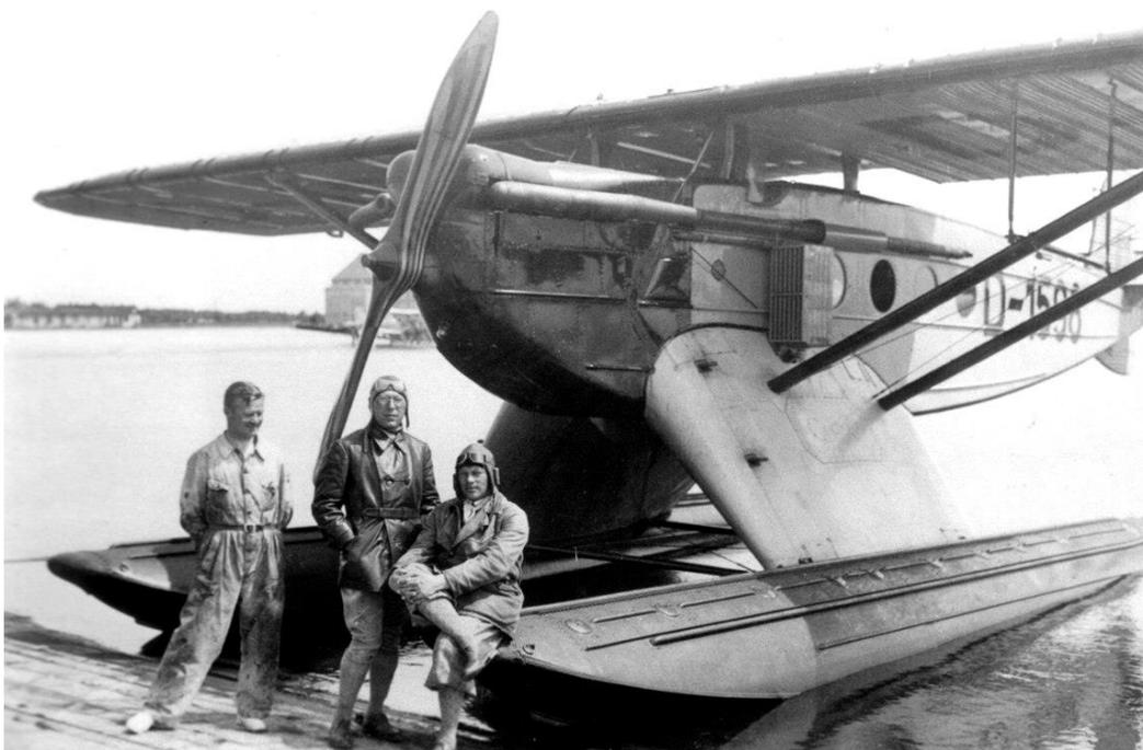
Auf diesem Foto der D-1598 (WNr. 188) sind sehr gut der seitliche „Ohrenkühler“ und die zusätzlichen Stützstreben zwischen den Schwimmern zu erkennen. Bereits nach kurzer Dienstzeit bei der DVS wurde der ursprünglich eingebaute BMW VI ZU durch einen getriebeleosen BMW VI Z ersetzt.
