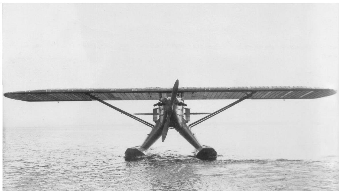
Die typische Silhouette der Do D in Frontansicht. Um einen unbehinderten Abwurf des unter dem Rumpf hängenden Torpedos zu gewährleisten, war auf jegliche Querverstrebung zwischen den Schwimmern verzichtet worden.
