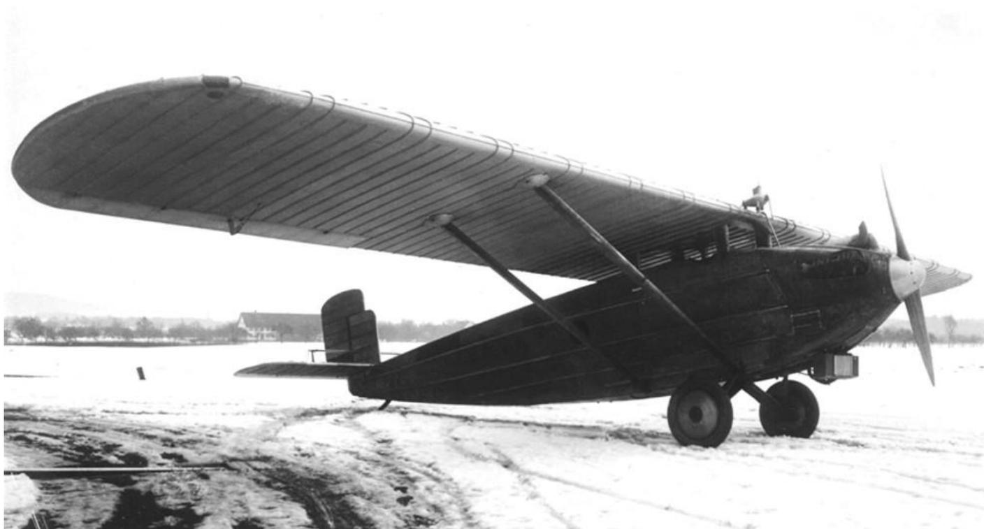
Die Bugpartie der zweiten Do C zeigte sich dank Bauchkühler und Propellerhaube nach dem Umbau erheblich strömungsgünstiger. (EADS, Historisches Unternehmensarchiv Dornier, Immenstaad)
