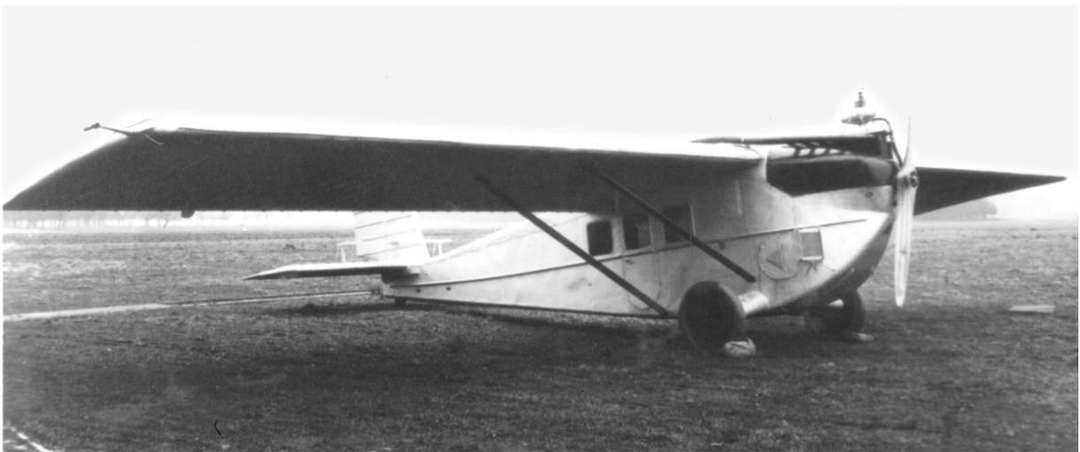
Die UWP zog 1925, nach dem Eintreffen der Komets III, mehrere Komets II aus dem Passagierflugdienst heraus und rüstete sie in eigener Werkstatt zu Luftbildmaschinen um. Nur die beiden mit BMW IIIa-Triebwerken ausgerüsteten Do P-Bal (WNr. 34 und 35) gingen offenbar zum Umbau an Dornier nach Friedrichshafen zurück. Sie erhielten den stärkeren BMW IV und tauchten 1925 bzw. 1926 als D-737 und D-1013 für kurze Zeit in der deutschen Luftfahrzeugrolle auf, bevor sie wieder nach Charkow zurückkehrten.
