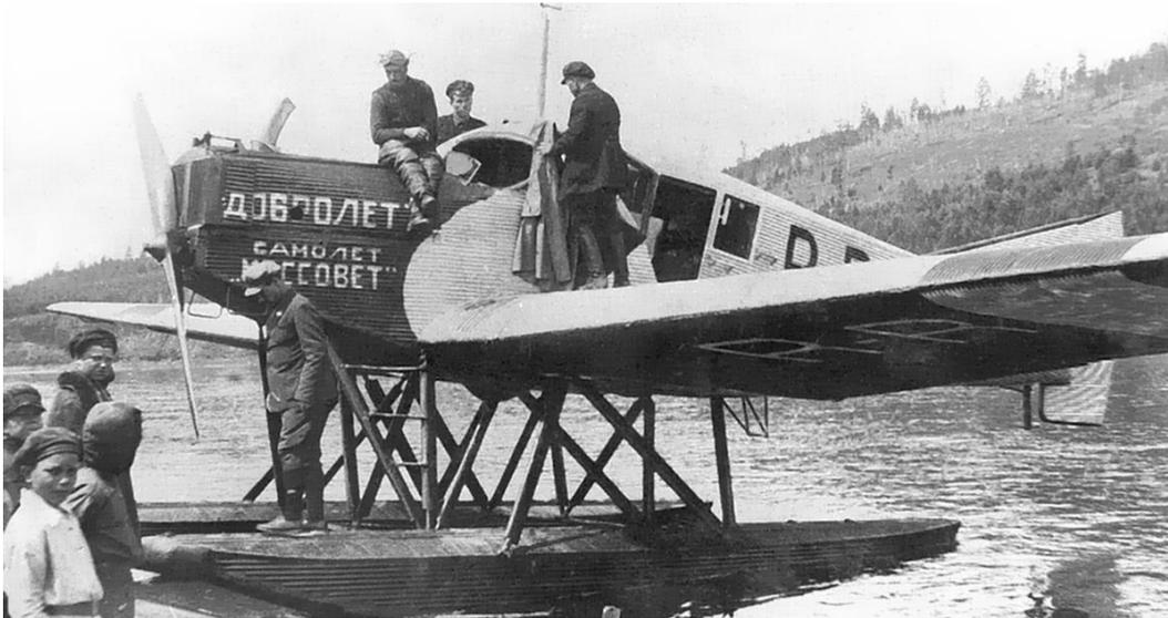
Die Junkers F 13 WNr. 649 „Mossowjet (2)“, Kennzeichen R-RDAA. Die Junkers-Maschinen konnten bei Bedarf mit vertretbarem Aufwand zu Schwimmerflugzeugen umgerüstet werden.
