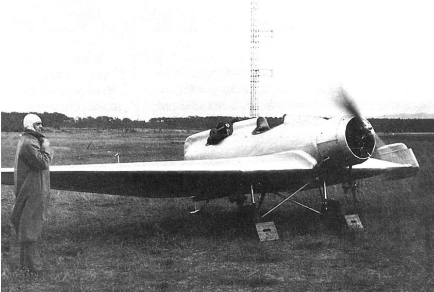
*Die zur „Delta IV a“ umgeänderte Maschine: Der Heckmotor ist ausgebaut, der Rumpf läuft in einer senkrechten Schneide aus, die Entenruder am Rumpfbug sind verschwunden. Links im Bild vor dem Flügel steht Dr. Alexander Lippisch.*
