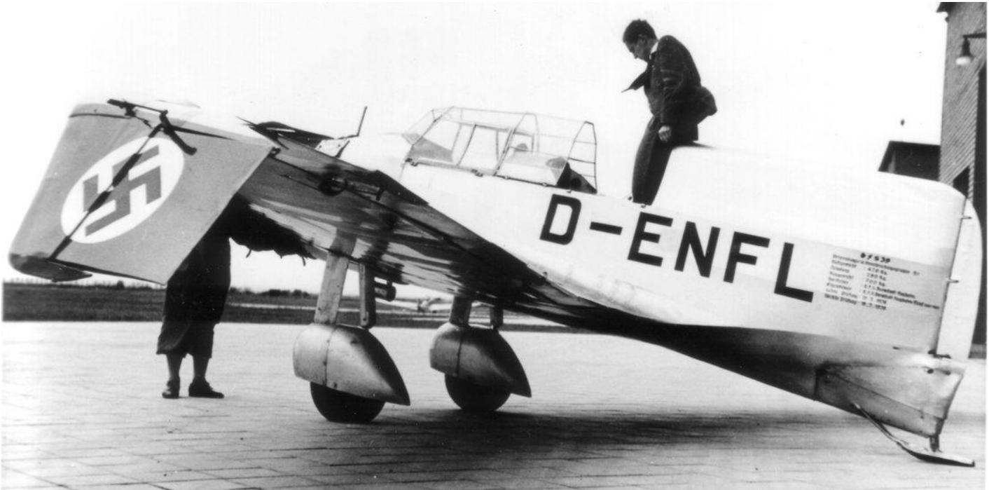
*Die „Delta IV c“ stellte die endgültige Version des Ursprungsmusters Fieseler „Wespe“ dar, hatte aber mit diesem nur noch wenig gemein. Das Flugzeug wurde unter der RLM-Bezeichnung DFS 39 zum Luftverkehr zugelassen und trug das Kennzeichen D-ENFL. Aus den am Heck angeschriebenen Prüfungsdaten läßt sich ableiten, daß dieses Foto zwischen März 1938 und März 1939 gemacht wurde. (Slg. Kössler)*
