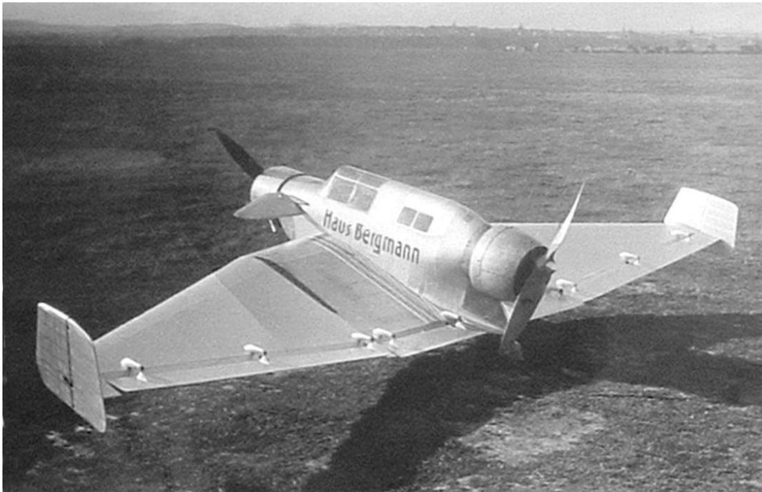
*Das Musterflugzeug startbereit auf dem Flugplatz Kassel. Der Besatzungsraum trägt erstmalig eine vollkommen geschlossene Verglasung. Gut zu erkennen ist die „Knickstelle“ auf dem Tragflächenmittelstück, wo der Außenflügel mittels Scharnieren hochgeklappt werden konnte. Alle drei „Wespen“ sollten mit dem Schriftzug „Haus Bergmann“ am Rumpf in den Europarundflug geschickt werden.
