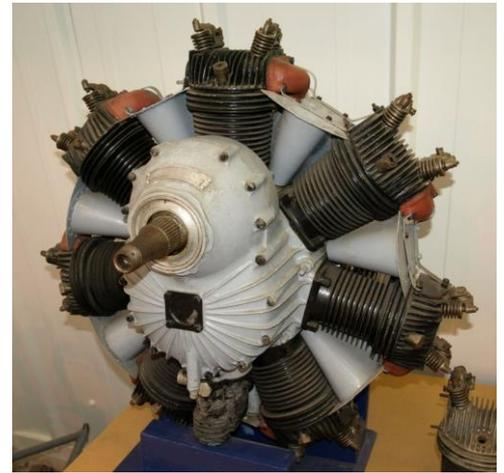
Der britische Siebenzylinder-Sternmotor Pobjoy „R“ diente zum Antrieb der Fieseler F 3. Er leistete 75/85 PS und war seinerzeit der leichteste in seiner Klasse. Bedingt durch das Getriebe befand sich die Propellerachse oberhalb der Motorlängsachse.
