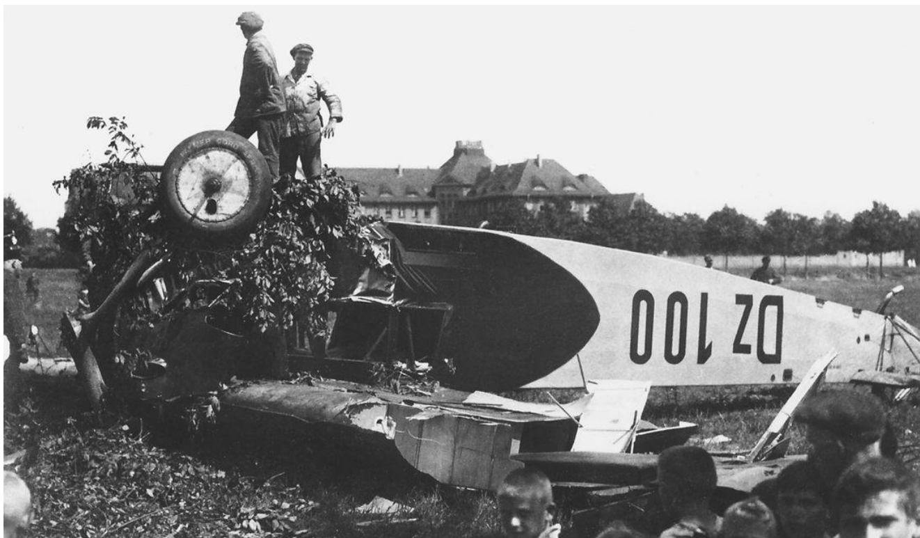
Am 26. Mai 1925 stürzte die Dz 100 kurz nach dem Start in Berlin-Tempelhof ab, weil der Motor versagte. Flugzeugführer Joachim Stollbrock trug zum Glück nur leichte Verletzungen davon, aber die Maschine mußte als Totalschaden abgeschrieben werden. (Fotos diese Seite unten und nächste Seite oben)
