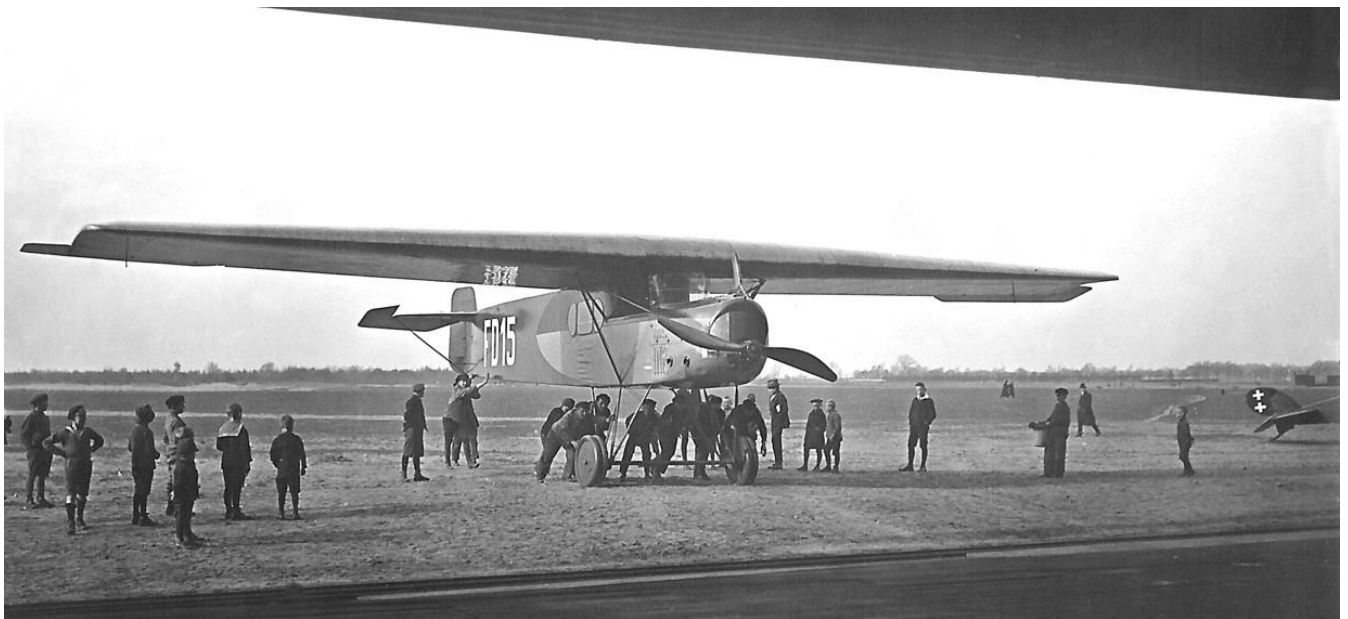
Die vordere Hälfte des Rumpfes der FD 15 war in den Farben schwarz und gelb lackiert, der Farbton der hinteren Rumpfpartie ist nicht überliefert. Die Flügel trugen eine Stoffbespannung mit aufgedruckten militärischen Tarnfarben, wie sie in den letzten Kriegsjahren ballenweise hergestellt wurden.
