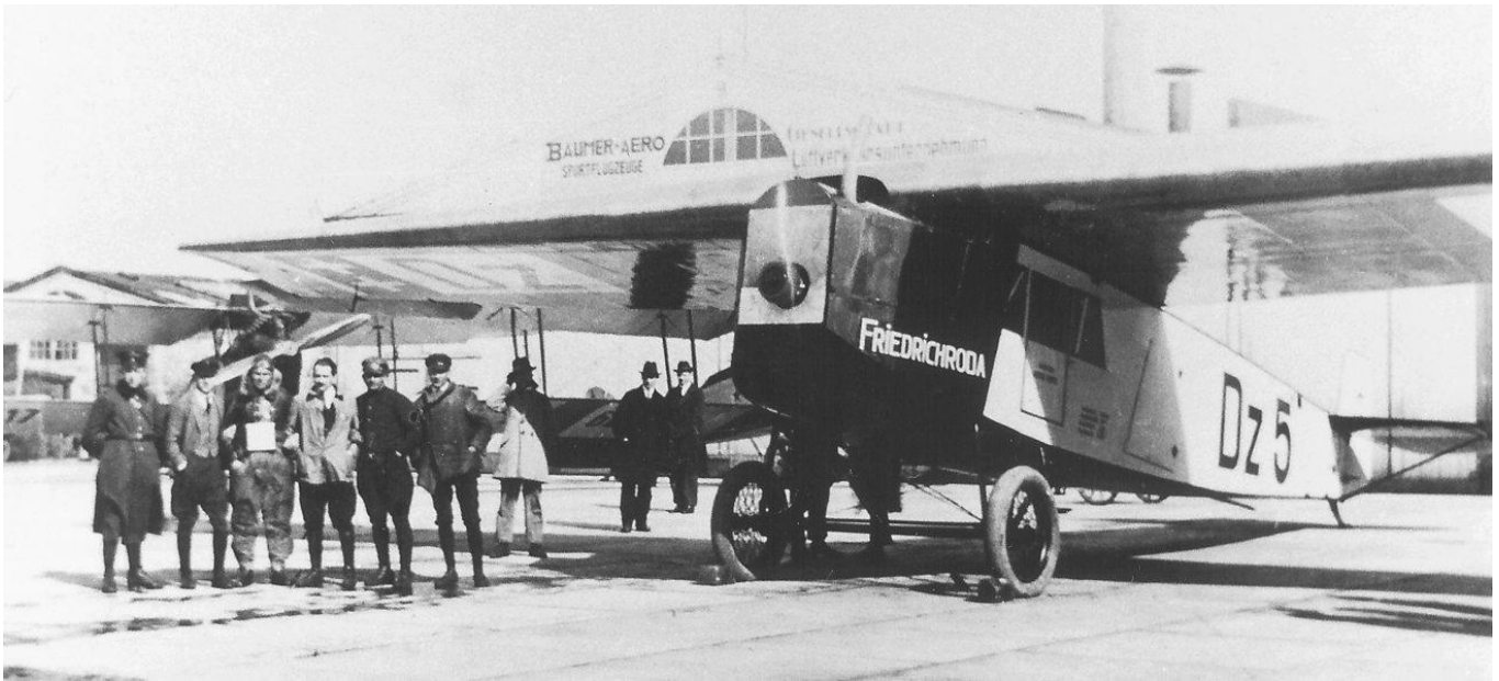
Die Fokker F III, Dz 5, im typischen Bemalungsschema von 1923-24: Firmennamen in kleinen Lettern an der Kabinentür, am Rumpfbügel der Flugzeugname „Friedrichroda“. Alle Fokker-Maschinen trugen beim Aerolloyd Städtenamen, die mit dem Buchstaben „F“ (wie Fokker) begannen.
