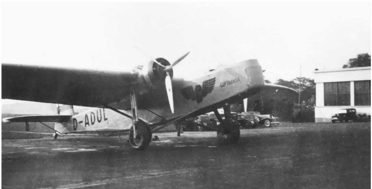
Ab 1936 kamen auf der Reichsbahn-Frachtstrecke Berlin - Danzig - Königsberg zweimotorige Frachtflugzeuge vom Typ Dornier Do F zum Einsatz, eine auf zivil getrimmte Version des Bombers Do 11.
