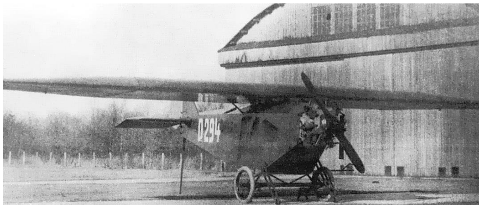
Das Muster CLE 16 war eine Weiterentwicklung des Typs CLE 11. Auf den beiden Fotos sind gut die Änderungen gegenüber dem Typ 11 zu erkennen: Die gerade verlaufende Flügelunterseite, das unverkleidete und nicht mehr unmittelbar unter dem Rumpf angeschlossene Fahrgestell sowie der gerade Rumpfboden. Die einzige Mustermaschine der CLE 16 entstand offensichtlich als Umbau aus der ursprünglichen CLE 11 D-294.
