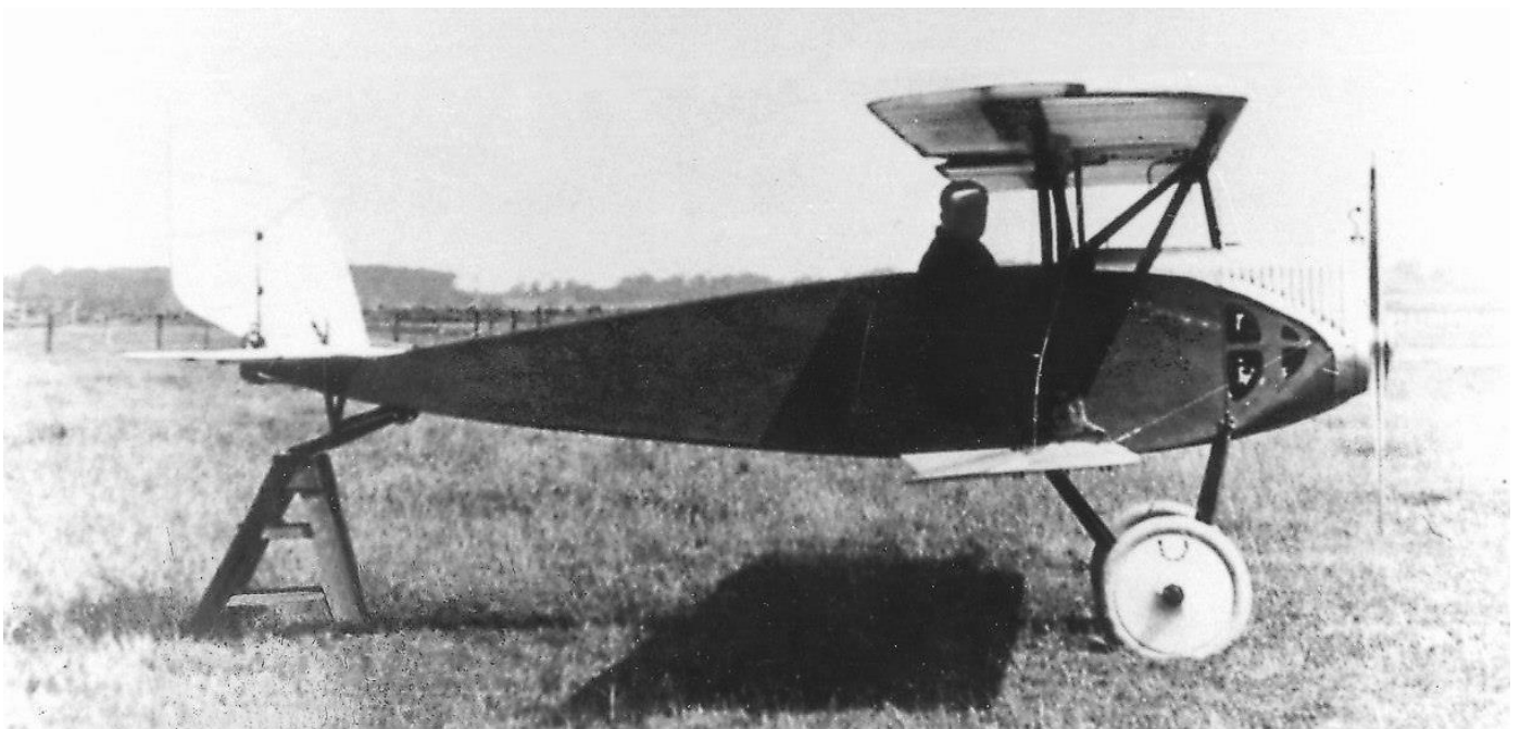
Im Gegensatz zu den anderen Caspar CT-Mustern war die CT 3 nur ein Einsitzer mit deutlich kleineren Abmessungen. Zum Antrieb diente ein Dreizylinder-Reihenmotor vom Typ Bolle & Fiedler, der 30 PS (22 kW) lieferte.
