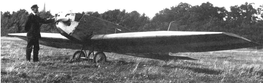
Die Caspar C 17 war ein zweisitziges Sportflugzeug mit einem englischen ABC „Scorpion“-Motor. Der freitragende Eindeckerflügel bestand aus zwei Hälften, die in Rumpfmittle mit Schnellverschlüssen gekuppelt waren.
