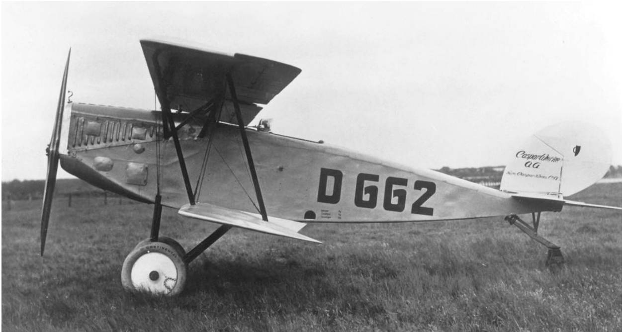
Die Caspar CT 1 besaß einen auf 80 PS gedrosselten Mercedes-Motor D I (provisorisch allgemein als D 0 bezeichnet). Die D-662 belegte beim Deutschen Rundflug 1925 unter Flugzeugführer Hans Ritter in der stärksten Klasse den 1. Platz. (Slg. Dabrowski)
