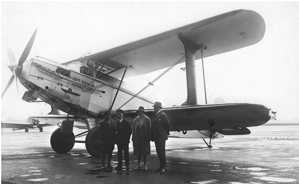
Die Caspar C 35 D-1360 blieb ein Einzelexemplar und flog bei der Luft Hansa in den Jahren 1929 und 1930 ausschließlich als Frachtflugzeug. Auf diesem Bild fällt die veränderte Abgasanlage des Motors auf, deren Rohr nun bis hinter die Flugzeugführerkabine reichte, um eine Beeinträchtigung der Piloten durch Abgasdämpfe zu minimieren.
