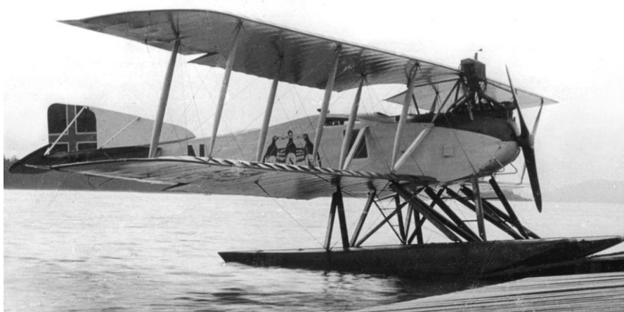
Die ehemalige D-73 im Einsatz bei der United Sardine Factory. Das Flugzeug trägt inzwischen norwegische Kennzeichen und hat ein kabinenartiges Dach über dem hinteren Sitz sowie Fenster im Rumpf. (Kay Hagby via G. Ott)
