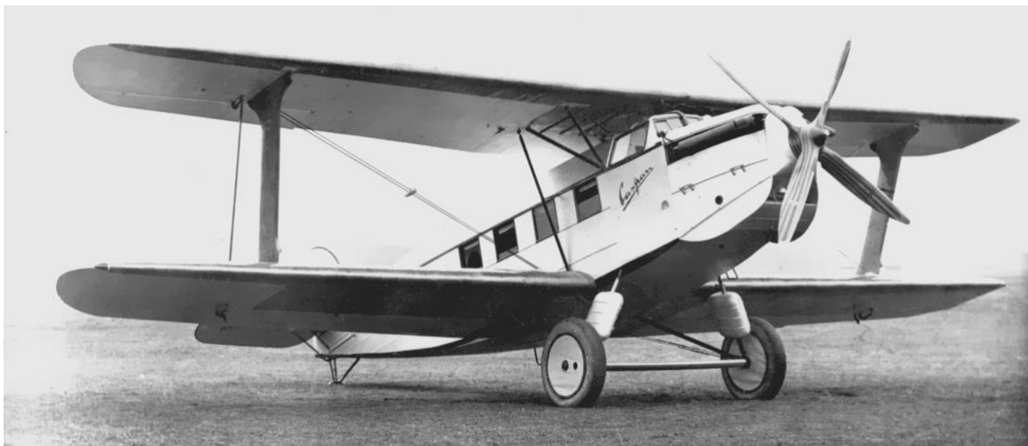
Das Verkehrsflugzeug Caspar C 35 war ein relativ großer Doppeldecker in Gemischtbauweise mit einer Kabine für 8 Fluggäste und einer geschlossenen Führerkanzel.
