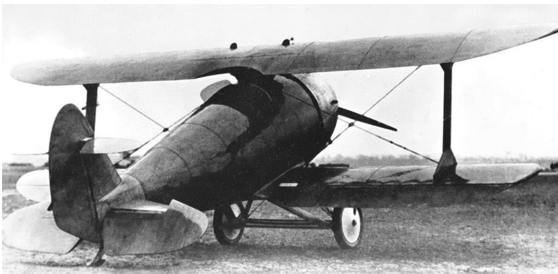
Zwei weitere Ansichten des Musterflugzeugs C 33. Zum Antrieb diente ein Siebenzylinder-Sternmotor, wie sich anhand der Abgasrohre abzählen läßt. Vermutlich handelte es sich um einen Siemens Sh 11.
