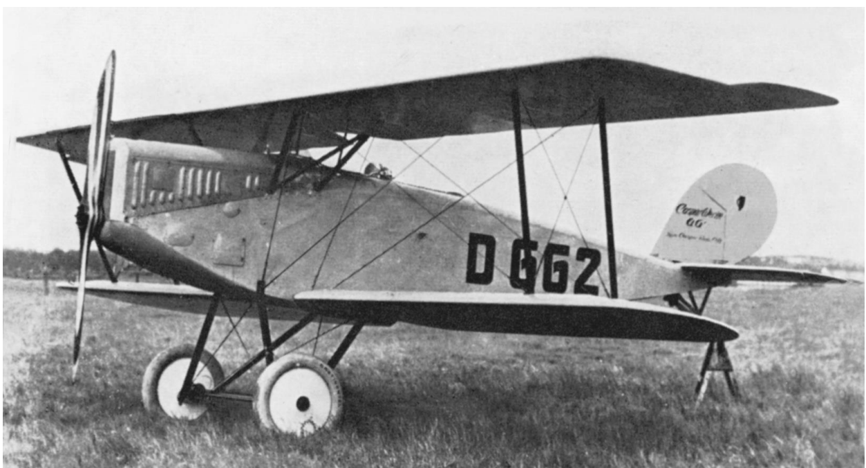
Die Caspar CT 1 besaß einen auf 80 PS gedrosselten Mercedes-Motor D I (provisorisch allgemein als D 0 bezeichnet). Die D-662 belegte beim Deutschen Rundflug 1925 unter Flugzeugführer Hans Ritter in der stärksten Klasse den 1. Platz. (Slg. Dabrowski)
