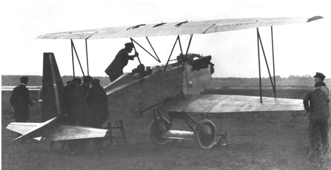
Jagdeinsitzer Caspar C 14, Version 2, ausgerüstet mit dem Hispano-Suiza 8 F-Motor. (Slg. Ott/ADL)
