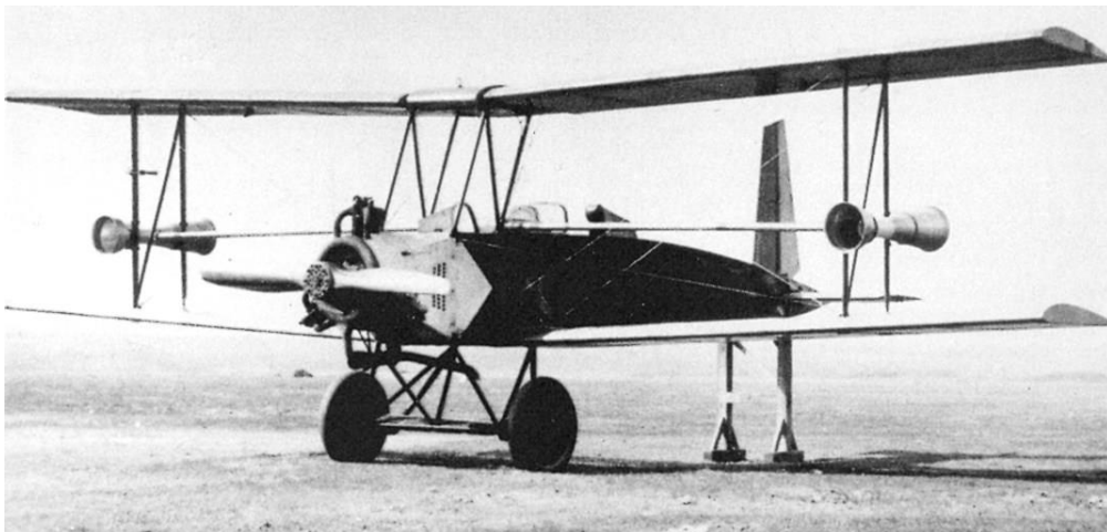
Die Caspar C 26 diente 1926 unter anderen auch für Streuflugversuche mittels Venturi-Düsen. Hierbei dürfte es sich um praktische Vorversuche für ein Arsen-Streugerät gehandelt haben, welches bei den Caspar-Werken für die C 32 in der Entwicklung war.
