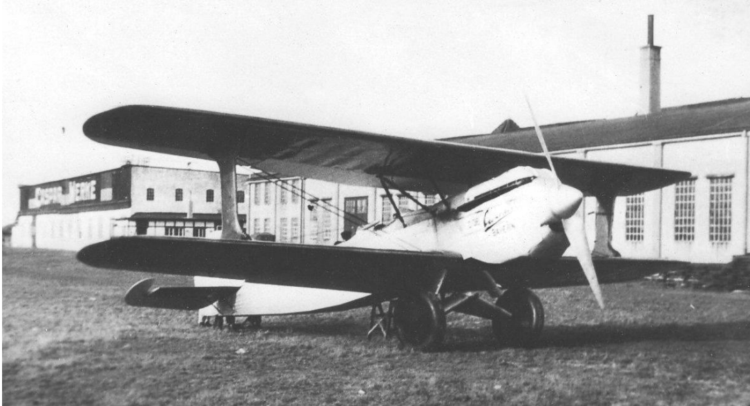
Dieses Bild entstand einige Monate später auf dem Flugplatz der Caspar-Werke. Inzwischen schrieb man das Frühjahr 1928 und die C 36 trug am Bug schon ihren Musternamen „Bayern“. Das Fahrgestell hatte zusätzliche Verkleidungen der Fahrwerkstreben erhalten und der Bugkühler besaß eine geänderte Stirnöffnung. (Slg. Ott/ADL)
