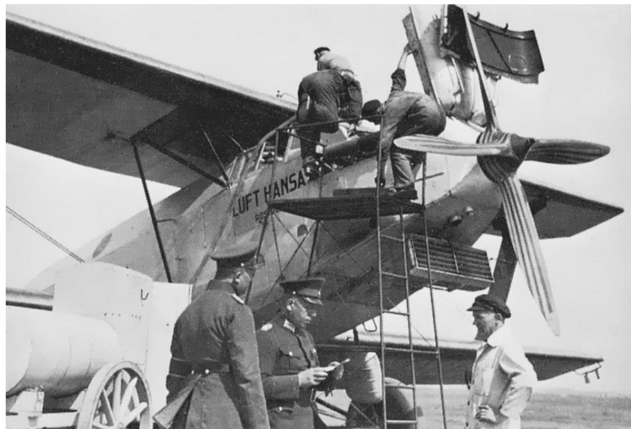
Die auffallende stromlinienförmige Verkleidung des Kühlers unter dem Rumpfbug kam nach dem Umbau zum Frachtflugzeug dauerhaft zum Fortfall.
