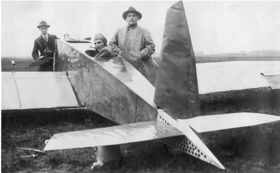
(links): Die Caspar C 17 während der Flügelmontage auf dem Flugplatz Travemünde. Am Fahrge- stell fehlen noch die Räder. Im Führersitz hat bereits probeweise Ein- flieger Alfred Münnich Platz genommen. Vorn am Propeller der Ma- schine steht Dipl.-Ing. von Lössl.
