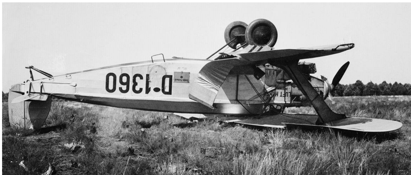
Am 2. Juli 1930 mußte die D-1360 in der Letzlinger Heide nahe dem kleinen Ort Dolle notlanden, weil das BMW-Triebwerk streikte. Dabei überschlug sich die Maschine aufgrund des ungünstigen Geländes und erlitt so große Schäden, daß sich ein Wiederaufbau nicht lohnte. Die Besatzung blieb zum Glück unverletzt. (beide Bilder: Slg. Ott/ADL)
