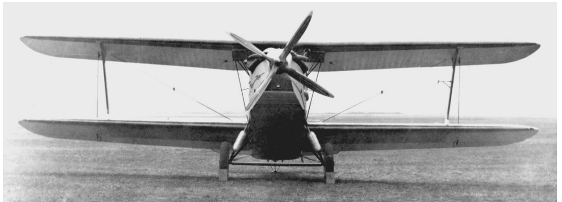
Das Verkehrsflugzeug Caspar C 35 war ein relativ großer Doppeldecker in Gemischtbauweise mit einer Kabine für 8 Fluggäste und einer geschlossenen Führerkanzel.
