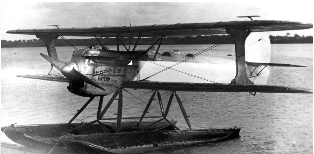
Im Laufe des Jahres 1928 wurde die Caspar C 36 zeitweilig von Landfahrgestell auf Schwimmer umgerüstet. In dieser Zeit bekam das Flugzeug auch den Beinamen „Bayern“. Ihre amtliche Zulassung D-1316 erhielt die Maschine erst im Juni 1929.
