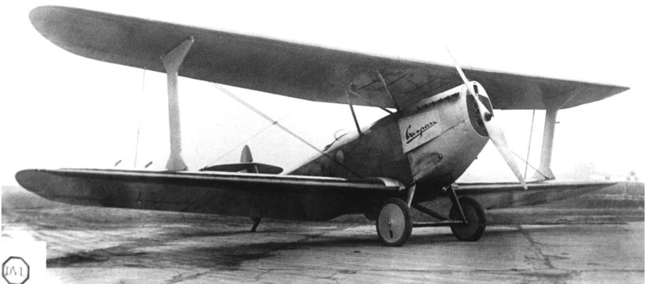
Die C 32 Werknummer 7009 (ehemaliges Kennzeichen D-1144) erhielt im Herbst 1927 Flügel mit vergrößerter Spannweite und teilweiser Sperrholzbeplankung sowie I-Streben aus Duralumin. Die offizielle Bauabnahme der nun mit Caspar C 34 bezeichneten Maschine erfolgte am 13.11.1927 bei der DVL in Berlin-Adlershof. Dabei entstand dieses Foto.
