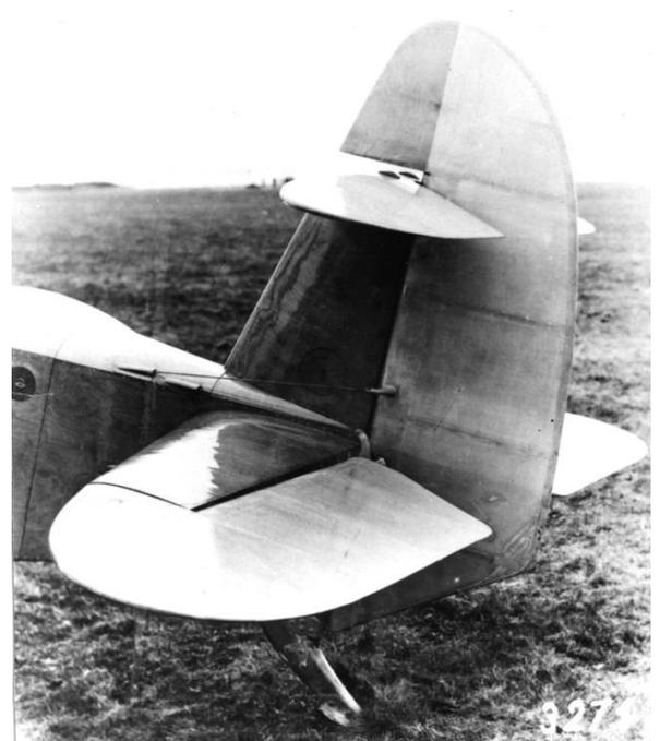
*Leitwerk der C 32 mit zusätzlicher Trimmflosse.*
