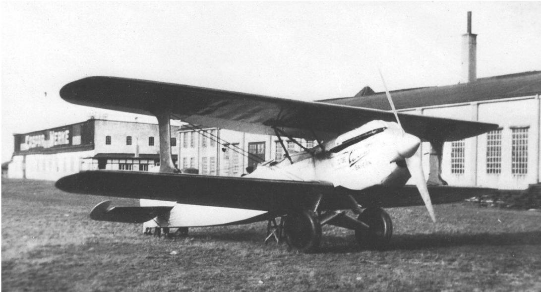
*Dieses Bild entstand einige Monate später auf dem Flugplatz der Caspar-Werke. Inzwischen schrieb man das Frühjahr 1928 und die C 36 trug am Bug schon ihren Musternamen „Bayern“. Das Fahrgestell hatte zusätzliche Verkleidungen der Fahrwerkstreben erhalten und der Bugkühler besaß eine geänderte Stirnöffnung.
