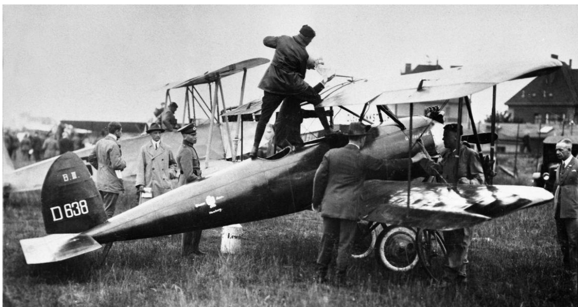
Tankpause auf einem der Zwangslandeplätze des Deutschen Rundflugs: Der im Oberflügel eingebaute Benzinhälter des „Alsterkinds“ wird mittels Trichter und Filtertuch im Handbetrieb befüllt. (Album Bäumer)
