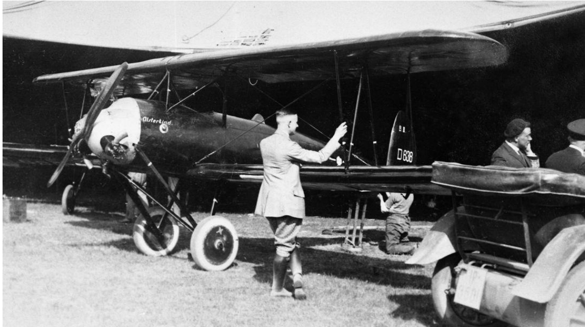
Die Pausen zwischen den Rundflugschleifen in Tempelhof wurden für Überholungsarbeiten am „Alsterkind“ genutzt. Alle Verstrebungen und Stiele, selbst die Fahrgestellfelgen, sind mit Siegeln bzw. Farbmarkierungen versehen, um ein unerlaubtes Auswechselln dieser Teile während des Streckenflugs zu verhindern. (Album Bäumer)
