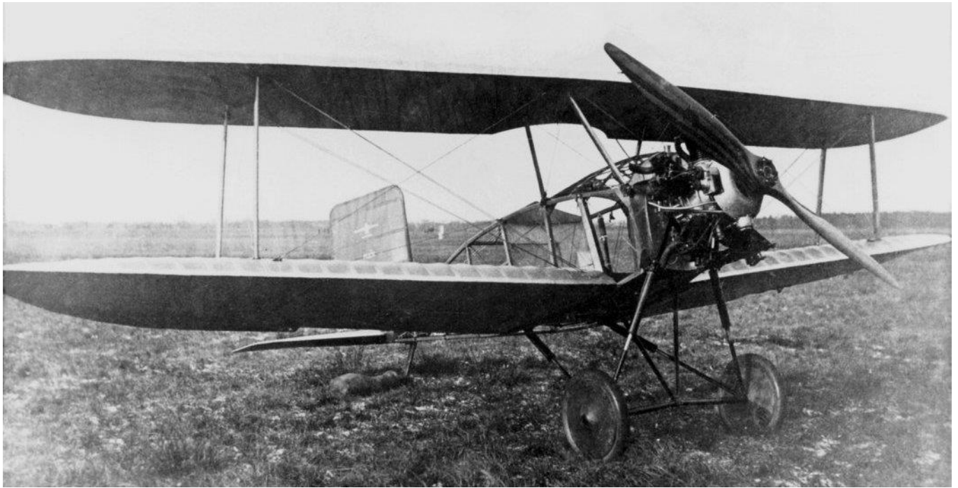
Bäume B V „Puck“, aufgenommen im Sommer 1927 auf dem Flugfeld in Hamburg-Fuhlsbüttel. Die Maschine ist zu 80% fertiggestellt, auch das Triebwerk eingebaut, nur Rumpfbespannung und Motorhaube fehlen noch.
