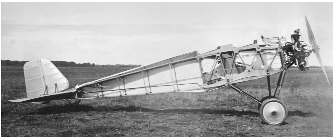
Zelle der „Schnecke“ ohne Flügel, rechte Rumpfseite ohne Stoffbespannung, Rumpfbug ohne Motorhaube (Slg. v.Langsdorff)
