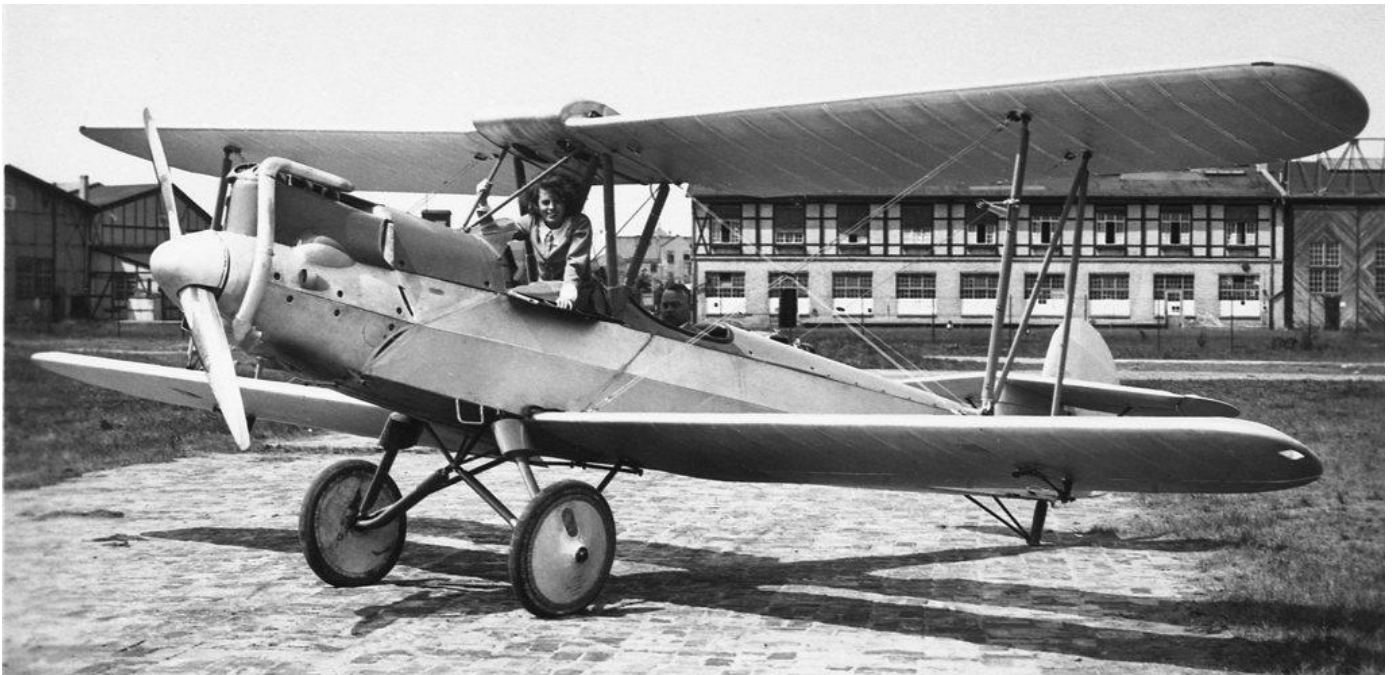
Die Albatros L 82 war vermutlich ein Konkurrenzmuster zur Bäumeer B VI. Sie hatte in der Ursprungsversion ebenfalls einen englischen Reihenmotor De Havilland „Gipsy“. Die junge Dame wurde nur zu Präsentationszwecken fotogerecht im vorderen Sitzausschnitt plaziert.
