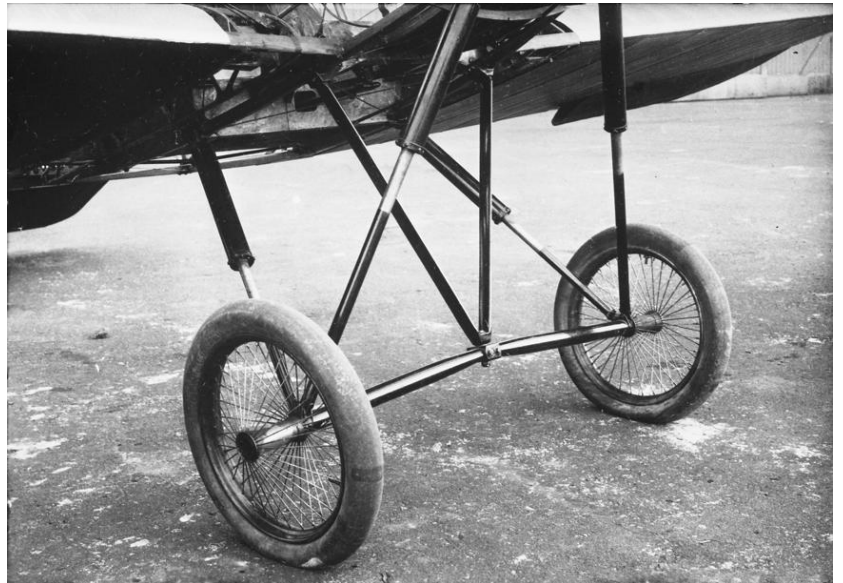
Detailaufnahme des „Puck“-Fahrwerks. Die äußeren Fahrgestellstreben waren alle mit Stoßdämpfern (Druckgummifederung) versehen. Die Stoffverkleidung der Radspeichen fehlt noch.
