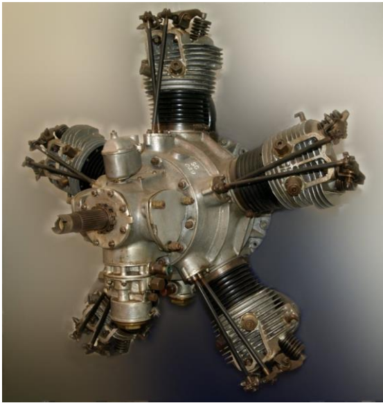
Der britische Sternmotor Armstrong-Siddeley „Genet“ (Leistung 65/75 PS, 48/55 kW) war für die B V „Puck“ vorgesehen. (Wikipedia)
