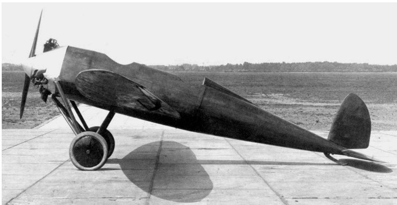
Die gerade fertiggestellte B II „Sausewind“ kurz vor ihrem Erstflug, Aufnahmedatum etwa 26. Mai 1925. Der Rumpf trägt schon einen Anstrich, ansonsten aber keine Beschriftung und Kennzeichnung. Der Wright-Motor besitzt noch die vom Herstellerwerk gelieferten Auspuffstutzen, man baute sie jedoch nach kurzer Flugzeit ab, da das Material den Beanspruchungen nicht gewachsen war. (unteres Foto Album Bäumer)
