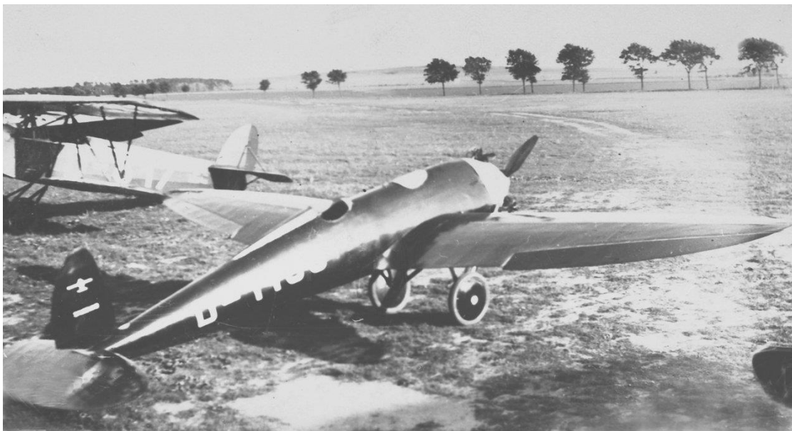
Wenn längere Flüge mit nur einem Insassen anstanden, konnte der vordere Sitz der Bäumer B IV mit einer festen Abdeckung versehen werden, um den Strömungsverlauf am Rumpf nicht unnötig zu verschlechtern.
