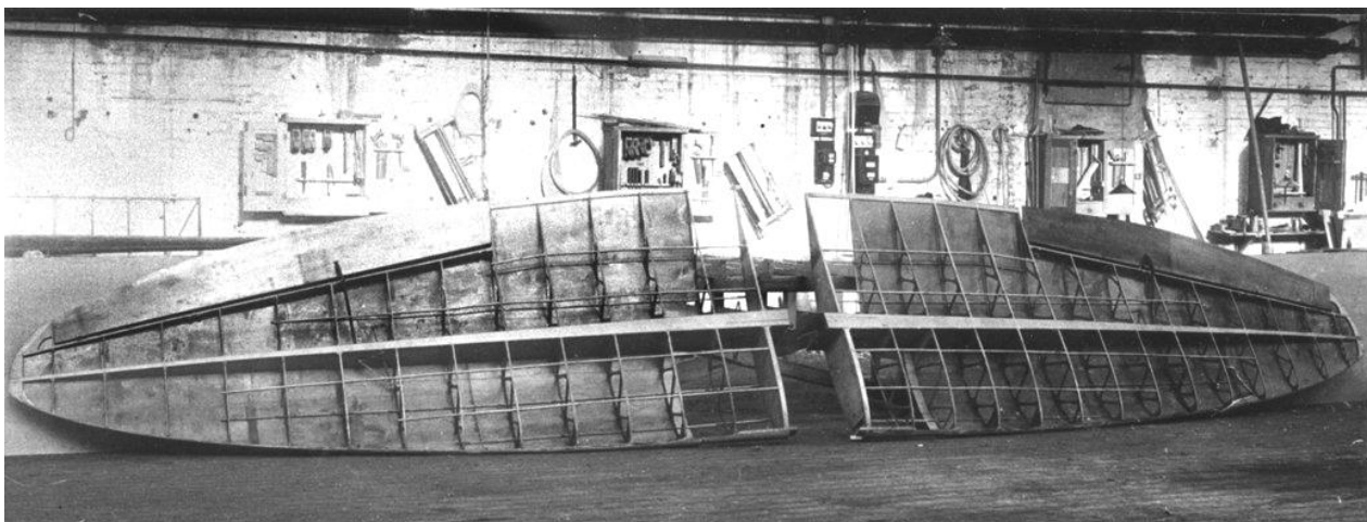
Tragflügel der B II „Sausewind“. Die Oberseite ist bereits mit Sperrholz bekleidet, die noch unbeplankte Unterseite gewährt einen interessanten Blick in den inneren Aufbau des Flügels. Gut zu erkennen sind der Kastenholm und die gegurteten Sperrholzsperren.
