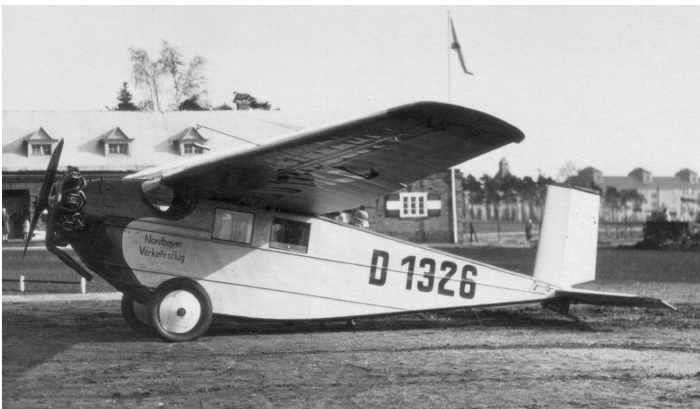
Die Messerschmitt BFW M 18 b erschien 1927, war eine Ganzmetallkonstruktion, konnte vier Passagiere befördern und wurde von der Nordbayerischen Verkehrsflug AG in größerer Stückzahl im Linienverkehr eingesetzt.
