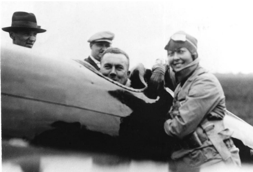
Auf diesem Foto der B II schaut Paul Bäumer aus dem hinteren Sitzausschnitt des „Sausewind“, neben ihm am Rumpf steht seine Schülerin Thea Rasche. Es läßt sich gut ermessen, wie tief der Pilot und sein Begleiter im Rumpf der Maschine saßen und wie eng die Ausstiegsöffnung im Verhältnis zu den Körperproportionen war.
