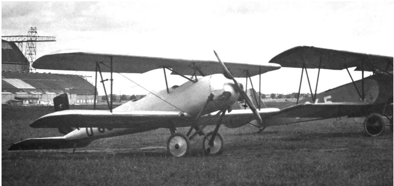
Der rote Anstrich ist einem lichten Hellgrau gewichen, das Seitenruder hat eine rechteckige Form, und die hinteren Fahrgestellstreben sind mit Druckgummifederung versehen. So präsentierte sich die Bäume B III im Frühjahr 1927 bei der DVS Staaken.
