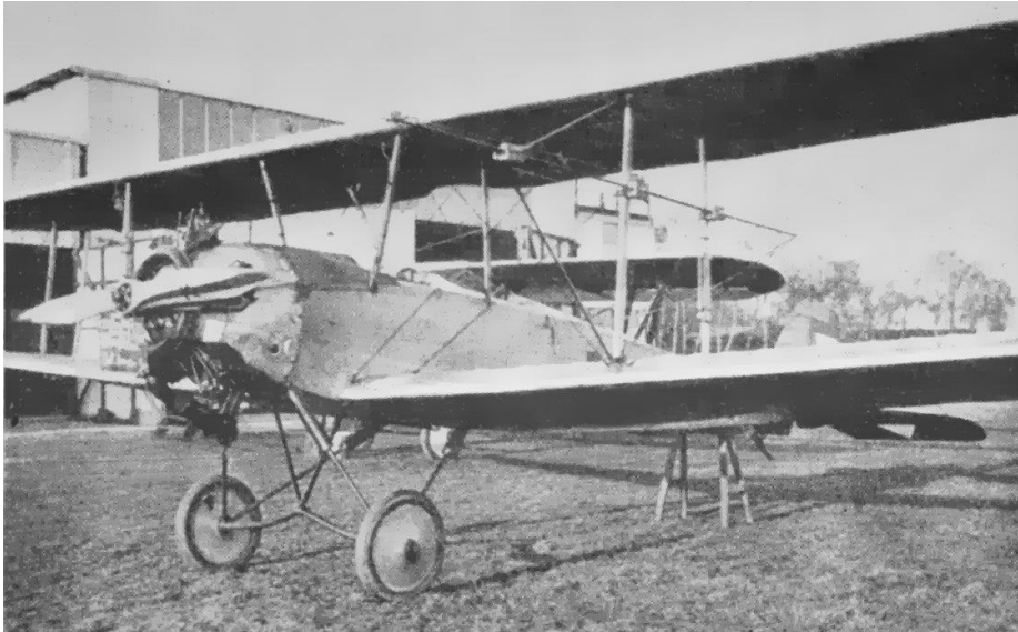
Die AFS 1 „Schnecke“ etwa März 1932, umgerüstet auf den Sternmotor Sh 13. Das neue Triebwerk leistete 68/80 PS (50/59 kW) und war mit einem zentralen Auspuffsammelring versehen.
