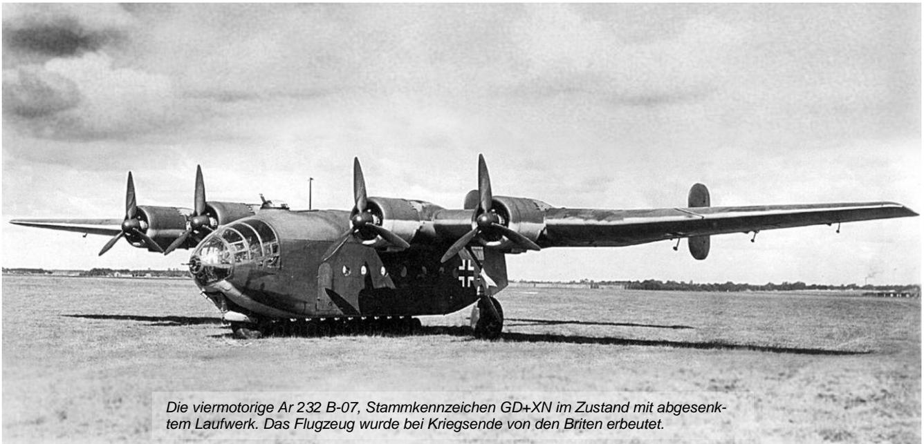
*Die viermotorige Ar 232 B-07, Stammkennzeichen GD+XN im Zustand mit abgesenktem Laufwerk. Das Flugzeug wurde bei Kriegsende von den Briten erbeutet.*
