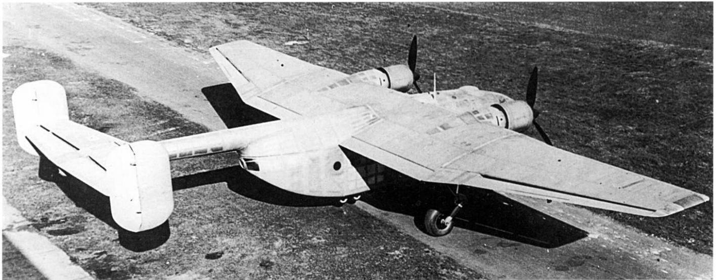
Die Ar 232 V1, der erste Prototyp der zweimotorigen Ausführung mit Triebwerken BMW 801 A, noch ohne Anstrich und Kennzeichen.
