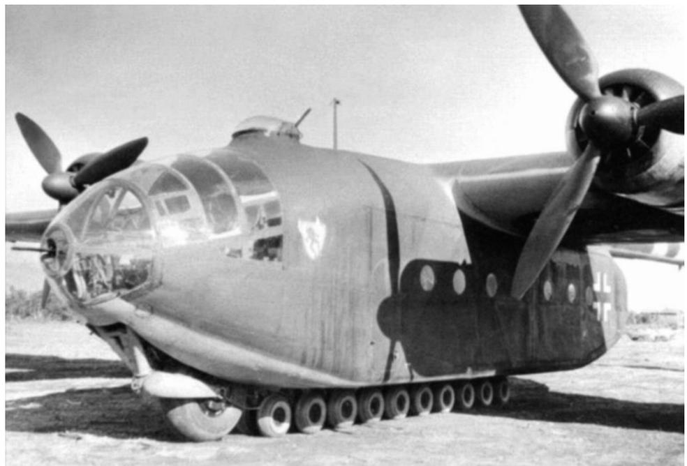
*Ar 232 A-10, Stammkennzeichen TC+EG, bei der Westa 5. Nach Einfahren des Bugrads und Absenken der Hauptfahrwerksfederbeine bekam eine Doppelreihe von als „Rollen“ bezeichneten kleinen Rädern unter dem Rumpf Bodenberührung. Damit konnten Vertiefungen und sogar Gräben überwunden werden.*
