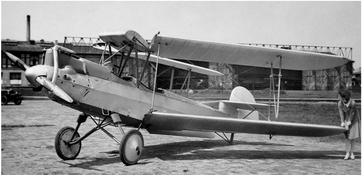
Die Außenflügel der Albatros L 82 ließen sich nach Entfernen von vier Bolzen komplett nach hinten an den Rumpf klappen, dabei mußten keine Steuerungsteile gelöst werden. Das Foto sollte werbewirksam demonstrieren, daß auch eine junge Dame in guter Garderobe diese Aufgabe problemlos erledigen konnte. (Slg. Koos/ADL und Ott/ADL)
