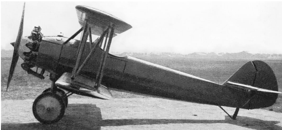
Seitenansicht der ersten Albatros L 79 „Kobold“, noch ohne Zulassung. Das Flugzeug war mit einem 9-Zylinder-Sternmotor Siemens Sh 12 ausgerüstet.
