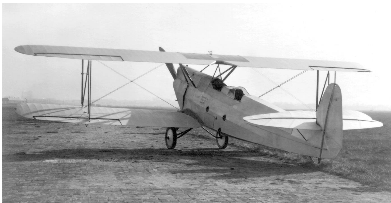
(Bilder oben und unten): Musterflugzeug Albatros L 75 „Ass“, angetrieben durch einen Sechszylinder-Reihenmotor BMW IV, Leistung 230/300 PS (169/221 kW). (Slg. Koos/ADL)
