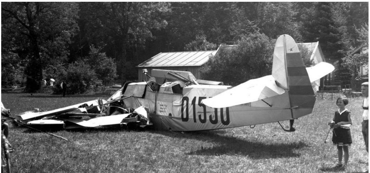
Bruchlandung der Albatros L 75 a, Zulassung D-1550, am Rand des Flugplatzes Bad Reichenhall wegen Motoraussetzer. Das Flugzeug gehörte zum Bestand der DVS Schleißheim und hatte den Auftrag, in Bad Reichenhall eine Meldung abzuwerfen. (diese Seite und nächste Seite oben)
