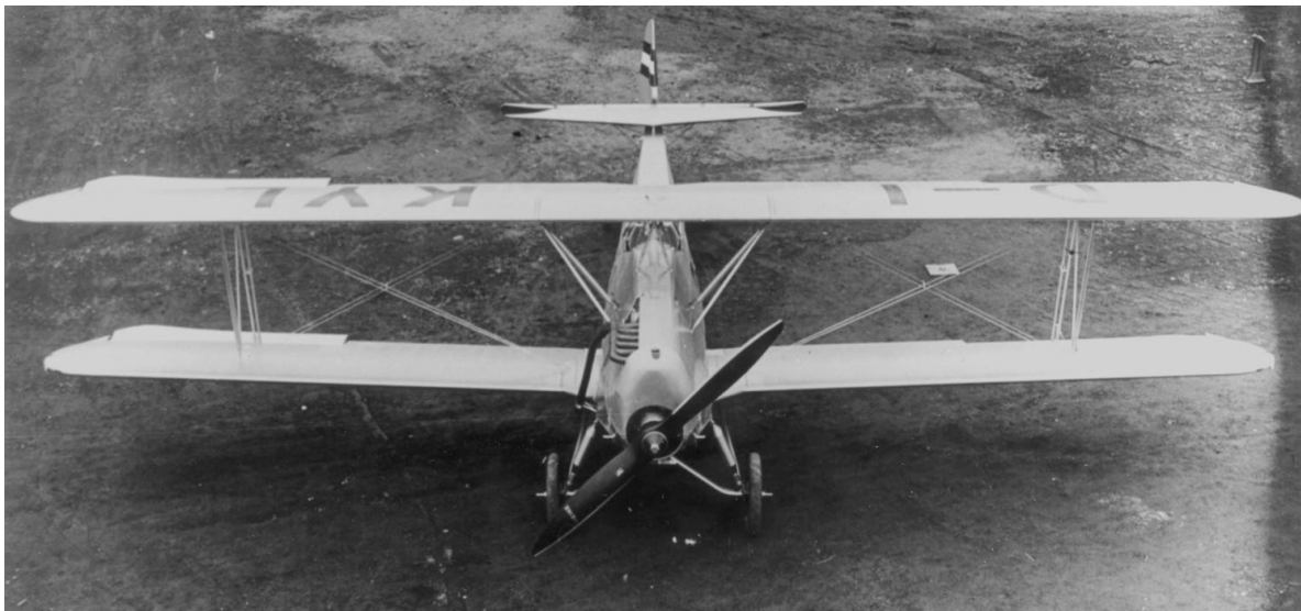
Albatros L 75 F, Kennzeichen D-IKYL. Bei dieser Ansicht schräg von vorn oben ist der dreieckige Rumpfquerschnitt mit abgerundeter Oberkante gut zu erkennen. (Foto VFW)
