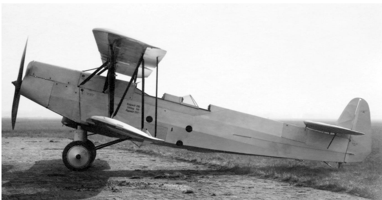
(Bilder oben und unten): Musterflugzeug Albatros L 75 „Ass“, angetrieben durch einen Sechszylinder-Reihenmotor BMW IV, Leistung 230/300 PS (169/221 kW). (Slg. Koos/ADL)
