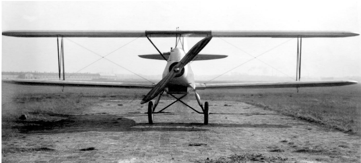
(oben): Frontansicht des Musterflugzeugs L 75. Aus dieser Perspektive ist der dreieckige Rumpfqerschnitt mit abgerundeter Oberkante gut zu erkennen. (Slg. Koos/ADL)
