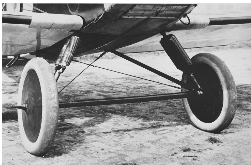
Das Fahrgestell der L 72 c war ähnlich demjenigen des Vorgängermusters konzipiert, wurde jedoch nicht mehr mit Luft gefedert, sondern besaß eine Druckgummifederung mit Öldämpfung.
