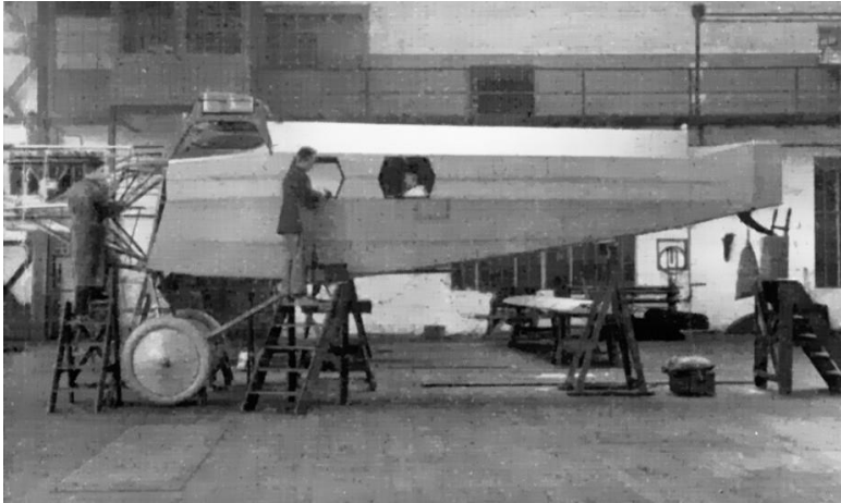
Rumpfmontage der Albatros L 72 a, oben im Baldachin saß der Benzintank. (Slg. Frost)
