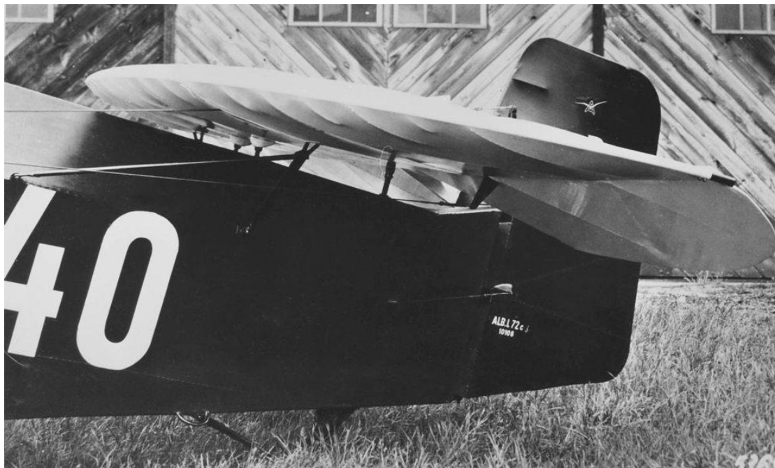
Das Leitwerk der L 72 c entsprach demjenigen der Version b, allerdings ruhte die Höhenflosse nicht mehr in einem besonderen Rumpfausschnitt, sondern lagerte oberhalb des Rumpfhecks auf Streben. Sie war wieder im Flug verstellbar, um Lastigkeitsänderungen nach Abwurf der Zeitungsladungen ausgleichen zu können. (Slg. Frost)
