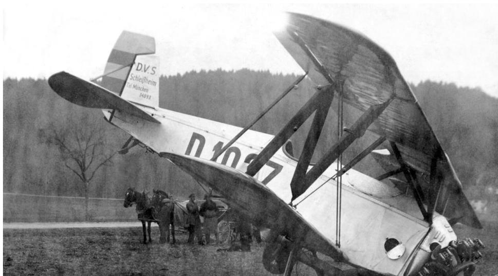
*Die L 68 a D-1027 der DVS Schleißheim erlitt am 21.04.1927 bei einer Außenlandung auf einem Stoppelfeld erhebliche Beschädigungen im Bugbereich und am Fahrgerüst. Der Unfallort ist leider nicht überliefert.*
