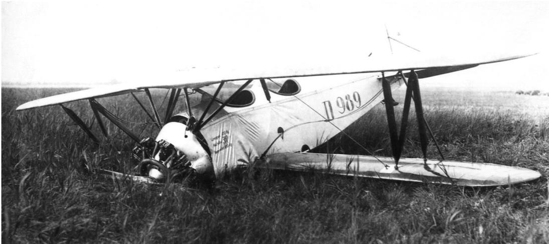
*Die frisch ausgelieferte L 68 a, WNr. 10082, war auf dem Papier schon zugelassen, trug aber ihr Kennzeichen D-989 erst in skizzierter Form am Rumpf. Zu einer ordnungsgemäßen Ausführung der Buchstaben und Ziffern kam es nicht mehr, weil die Maschine am 3.8.1926 in Staaken nach einem Motorsausfall beim Trudeln abstürzte.*
