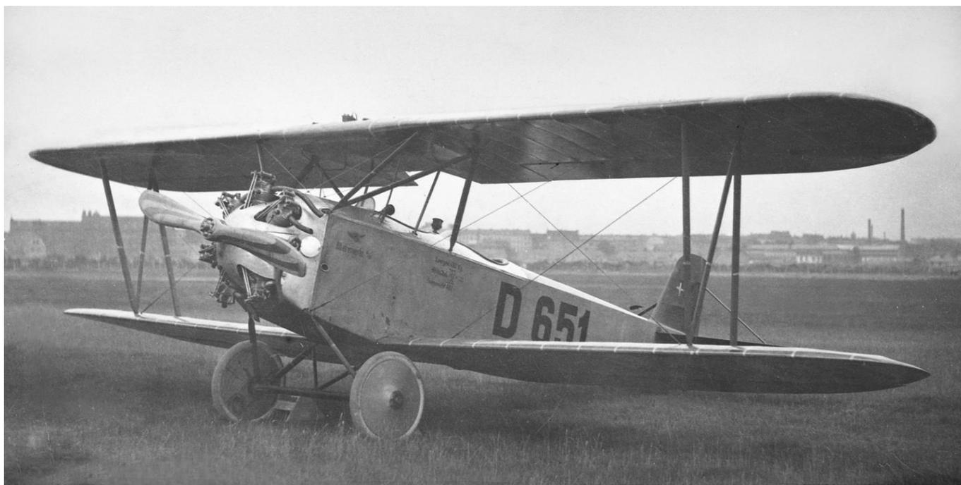
*Von dem Albatros L 68- Grundmuster wurden insgesamt drei Exemplare gebaut, eines davon war die Werknummer 10040 mit dem Kennzeichen D-651. Das Foto ist vermutlich im Frühjahr 1925 entstanden und zeigt die Maschine noch in ihrem ursprünglichen Aussehen ohne Auspuff-Sammelring am Siemens Sh 11-Sternmotor. An der Rumpfsseitenwand hinter der Motorhaube ist der Firmenschriftzug „Albatroswerke A/G“ zu erkennen und darüber das frühe Albatros-Firmen-Emblem.*
