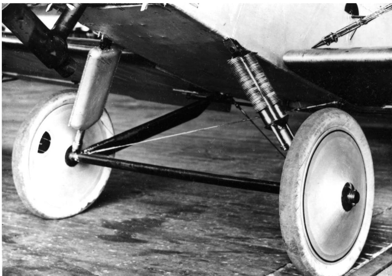
*Albatros L 68 c, Detailansicht der verbesserten Fahrgestellkonstruktion mit Federung per Druckgummi in Kombination mit einer Öldämpfung Bauart Albatros. (VFW)*
