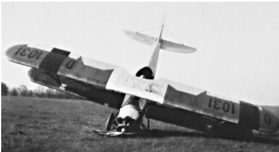
*Die Alb L 68 a, Kennzeichen D-1031, setzte am 22.02.1927 bei der Landung auf dem Flugplatz Stettin-Kreckow zu früh auf. Dabei wurde die Fahrgestellverankerung beschädigt, sodaß die Maschine beim Ausrollen nach vorn kippte.*
