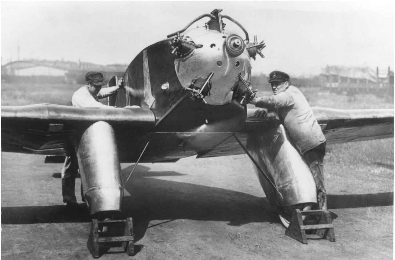
*(oben): Der Siemens-Motor des frisch fertiggestellten Einsitzers L 59 wird im Stand abgebrems. Charakteristisch für den Albatros-Tiefdecker waren die hosenbeinartigen Fahrstellverkleidungen zur Minimierung des Strömungswiderstands.*
