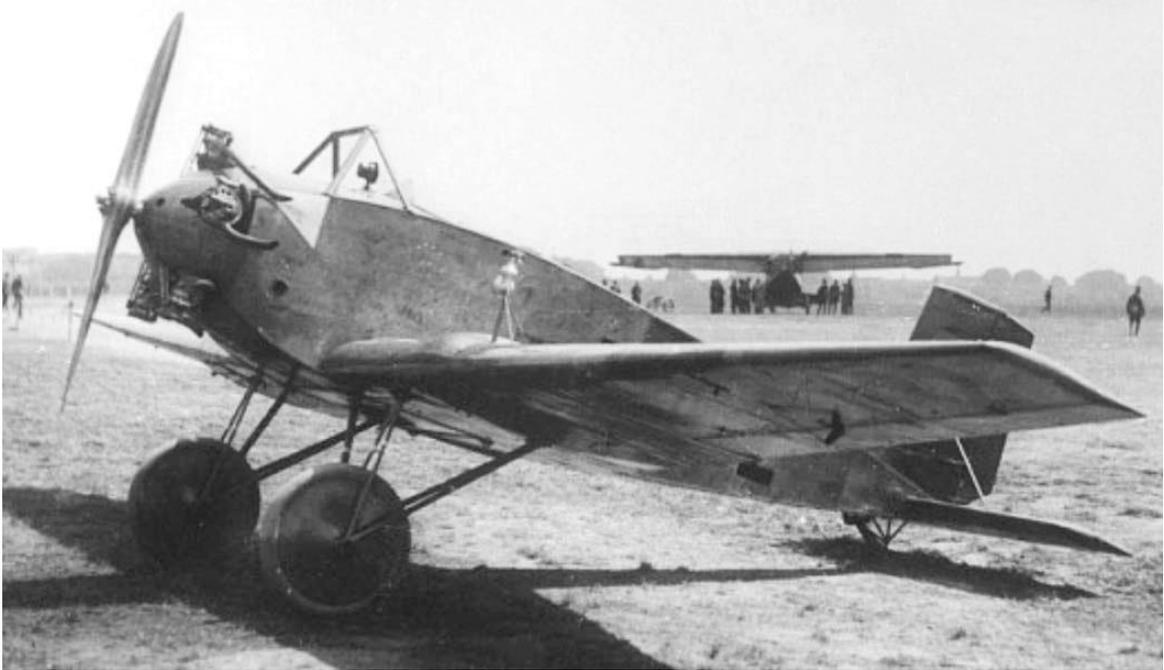
*Die Albatros L 59 D-632 im Jahr 1925 während des Deutschen Rundflugs. Ins Auge fällt der nachträglich montierte Überschlagbügel vor dem Pilotensitz. Er sollte die Besatzung schützen, wenn die Zelle nach einem Kopfstand auf dem Rücken liegenblieb. Bei Hochdeckern und Doppeldeckern waren solche Überschläge normalerweise mit viel geringeren Gefahren für die Flieger verbunden.*
