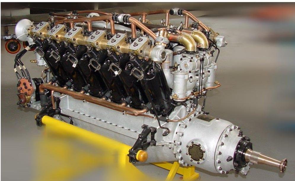
*Als Antrieb war in der Hälfte der gebauten L 58 der britische Zwölfzylinder-V-Motor Rolls-Royce „Falcon III“ (260/285 PS, 191/210 kW) eingebaut – so auch in der D-221.
