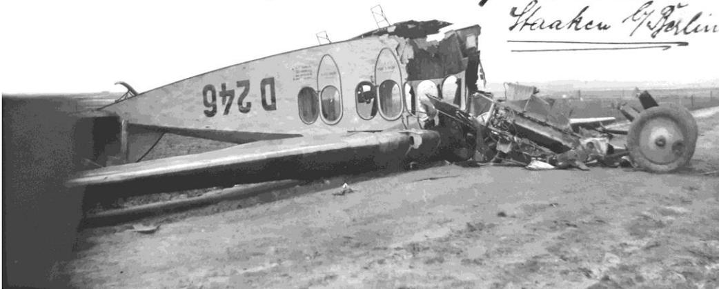
Am 13.8.1923 mußte Flugzeugführer Pieper mit der D-246 bei Meppen (im Emsland) infolge Benzinrohrbruchs notlanden. Nach erfolgter Reparatur setzte während des Wiederstarts der Motor aus, beim erneuten Landen geriet die Maschine mit dem Fahrgestell in einen Graben und überschlug sich. Die Schäden an der Zelle waren erheblich, trotzdem wurde das Flugzeug wieder aufgebaut. (Slg. Tob. Weber via G.Ott/ADL)
