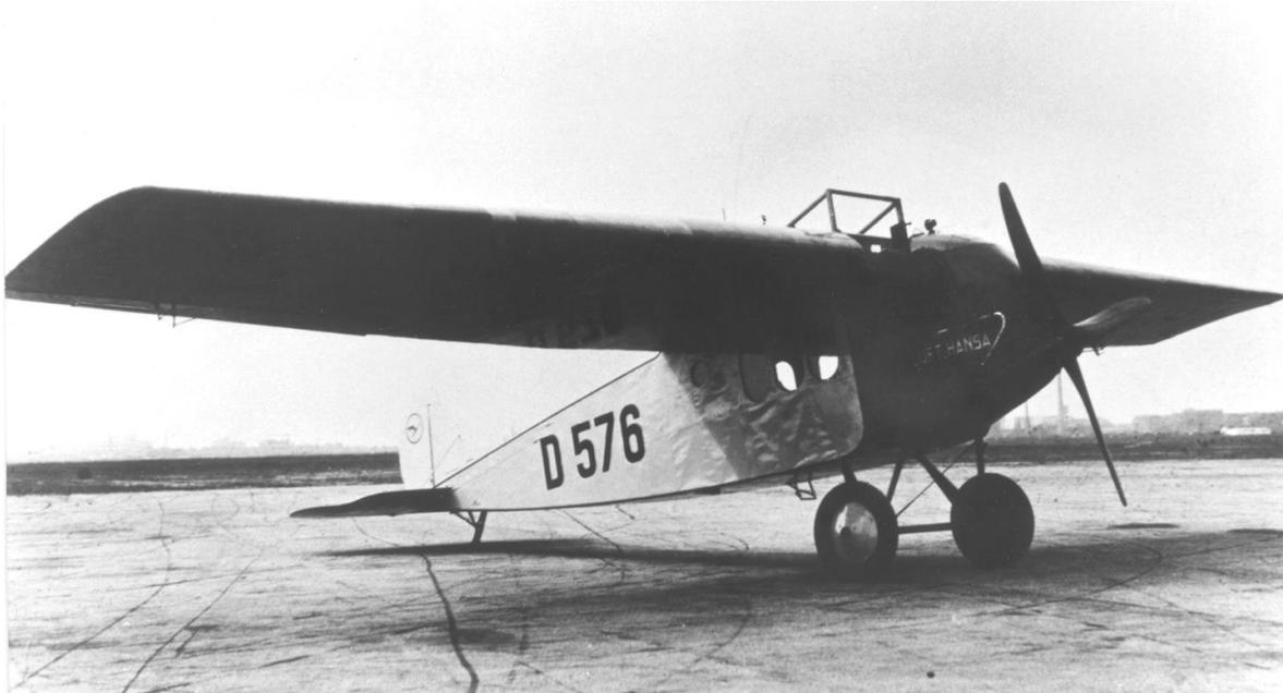
*Bei der Luft Hansa trug die D-576 den Namen „Wolkensegler“. Wegen des stärkeren Motors und des geänderten Vorderrumpfs wurde das Flugzeug nun als L 58 A (auch L 58 a) bezeichnet. Zum besseren Schutz des Flugzeugführers bei Notlandungen war hinter der Pilotenkanzel auf der Flügeloberseite ein stabiler Überschlagbügel angebracht.*
