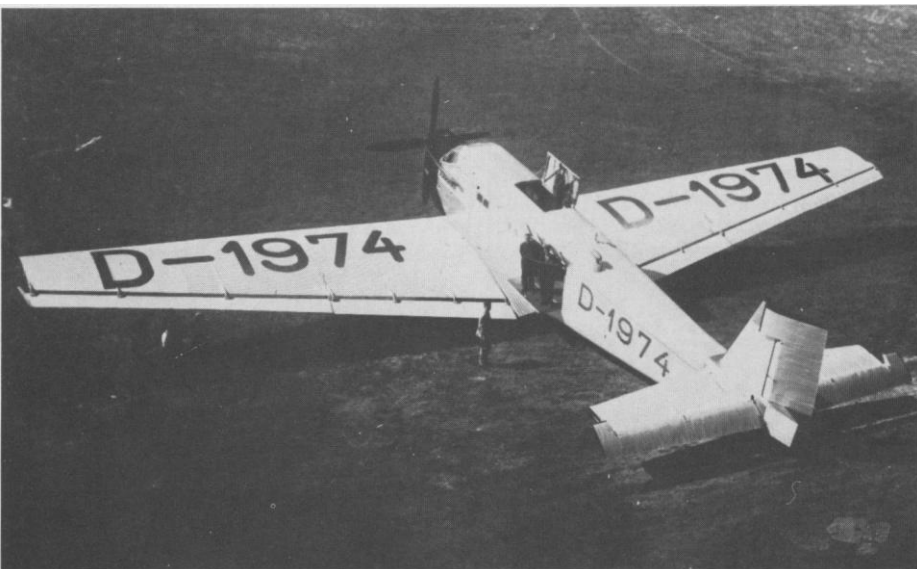
Die Werknummer 4001 in der Ausführung Ju 52 be. Gut ist die für dieses Muster typische gestreckte Tragflächenvorderkante zu erkennen.
