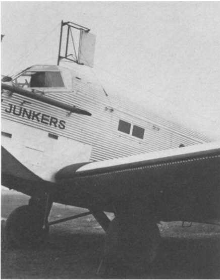
Zur Untersuchung der Schiebewirkung wurde an der Werknummer 4001 unmittelbar hinter dem Führerstand ein mit dem Seitenruder gekoppeltes Hilfsruder angebracht.
