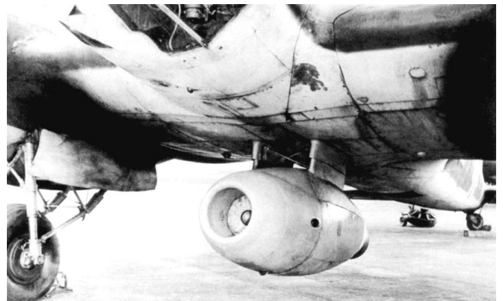
Die Erprobung des weiterentwickelten Triebwerks He S 6 erfolgte unter einer He 111.
