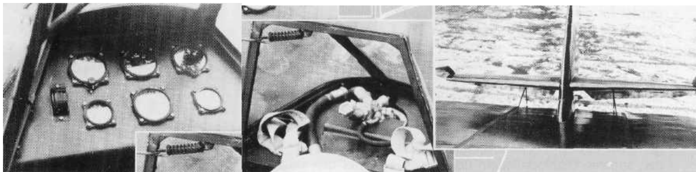
AS 6 V 1 im Detail (von links): Das spartanische Instrumentenbrett, der Tankfüllstutzen hinter dem Sitz im Cockpit, Streben und Versteller zur Höhenflosse
