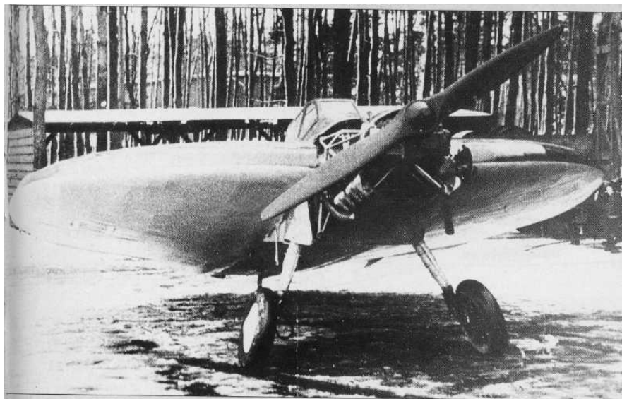
Im Sommer 1944 nach der Reparatur: AS 6 nun mit Motorhaube, zurückver- setztem Hauptfahrwerk, hohem Sporn- rad, Bügelkanten am Höhenruder, veränderter Cockpithaube sowie ande- ren Hoheitszeichen und Markierungen. (Fotos: Sammlung Späte)
