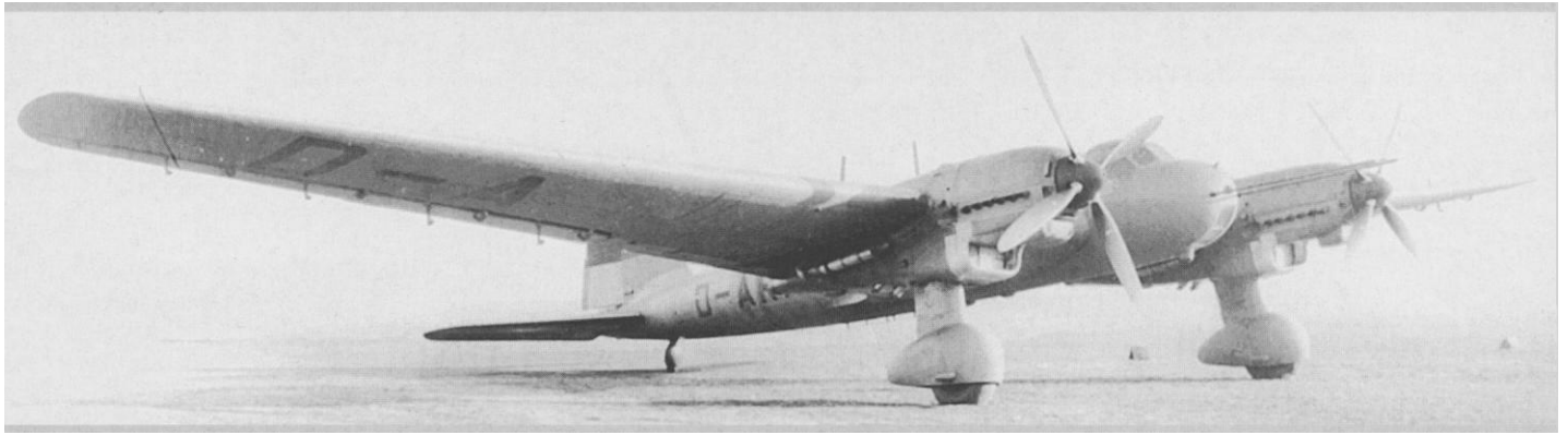
Das beste der wenigen bisher bekannt gewordenen Fotos der Hs 128 zeigt die D-ARHD, wobei deutlich die noch unvollständige Abgasführung sichtbar wird.
