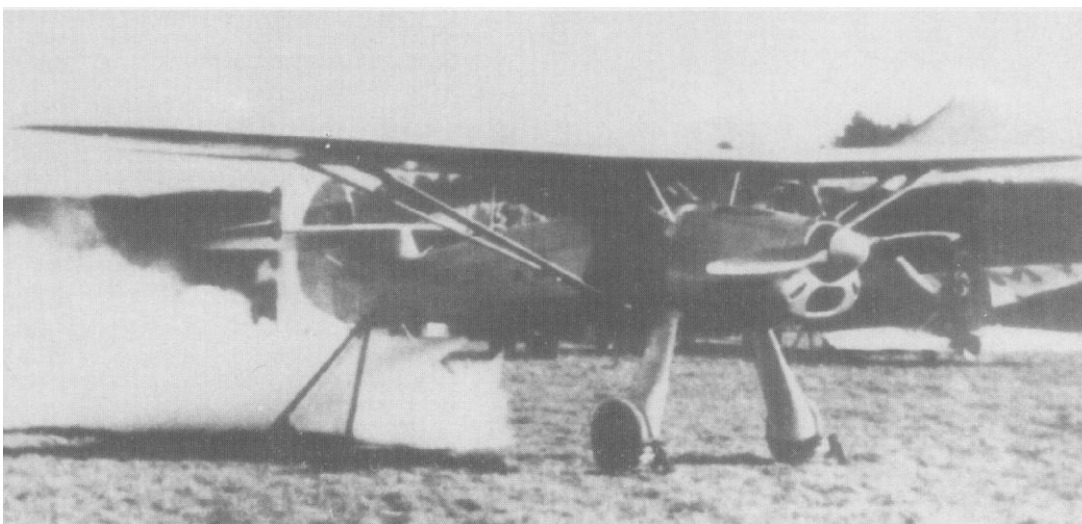
Probelauf des im Rumpf einer Fw 56 eingebauten Walter-Versuchstriebwerks in Neuhardenberg. Deutlich sichtbar ist der beim kalten Triebwerk entstehende Dampfstrahl. Im Hintergrund steht eine der für die Raketenversuche benutzten Heinkel He 112. Nach den erkennbaren beiden letzten Buchstaben der Zulassung handelt es sich entweder um die He 112 A-03 D-IZMY (Werknr. 1957) oder die He 112 V4 D-IPMY (Werknr. 1974). Foto: PRO, London
