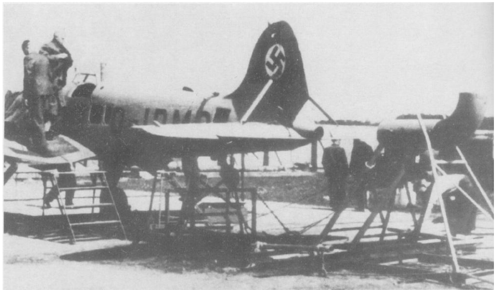
Vorbereitung zum Versuchsflug des Raketennotors in der He 112 V3 D-IDMO (Werknr. 1292).
